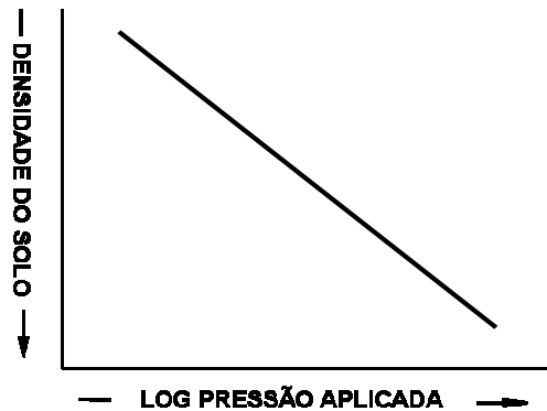
FIGURA 2. Curva de compressão do solo quando este não sofreu nenhuma pressão prévia. Fonte: Dias Júnior & Pierce (1996).
