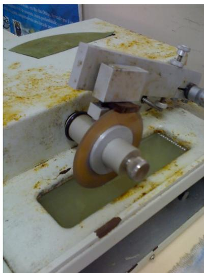
Figura 5: Serra metalográfica utilizada para secção dos otólitos.
