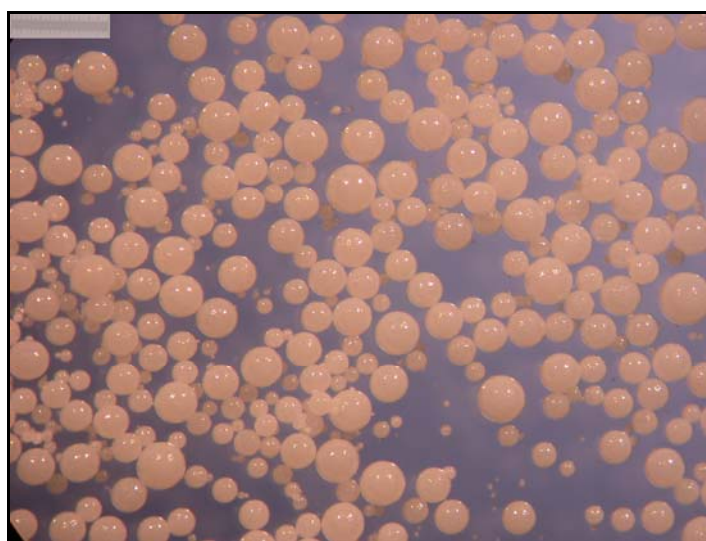
Figura 5.4.4 – Distribuição de tamanhos de partícula para reação com incorporação de 20% PS-Rec/estireno; analisado pelo (a) LS 13 320 e (b) PSDA; micrografia da amostra final da reação
