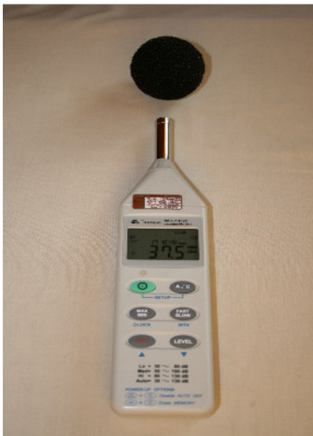
Figura 14 - Medidor do nível de pressão sonora MINIPA, modelo MSL-1352C / DIGITAL. FONTE: O Autor.
