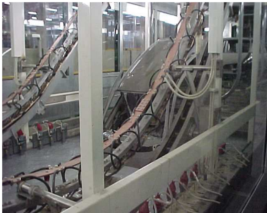
Figura 10 – Carroceria entrando em um banho de catforese
