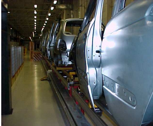
Figura 5 – Entrada de carrocerias no túnel de tratamento de superfície
