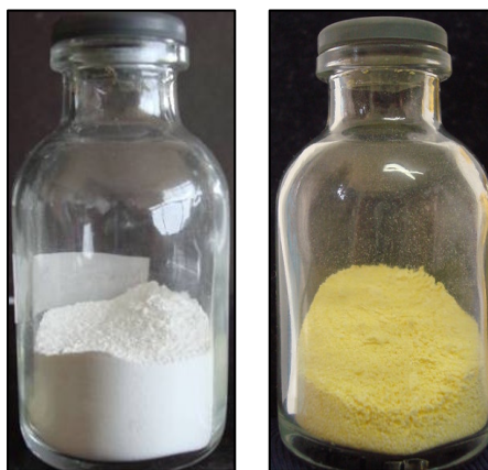
FIGURA 7 – Fotografia do óxido de nióbio sintetizado antes (a) e após (b) o tratamento com H_2O_2 .
