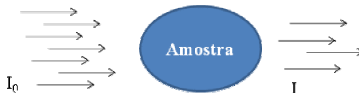
Figura 2.1 - Absorção de fótons pela amostra, ( I_0 > I ).
