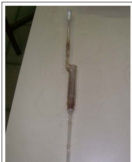
Figura 3.3 - Reator de quartzo
