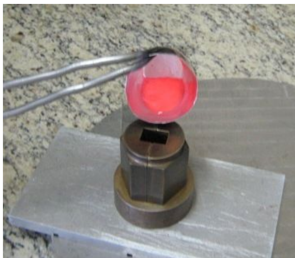
Figura 2.2- Líquido resultante da fusão dos reagentes sendo despejado em um molde de latão.
