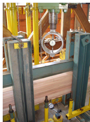
Figura 5.5 – Detalhe do contraventamento na região central da viga
