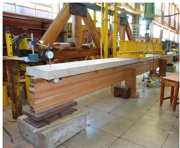
Figura 5.30 – Relógios comparadores posicionados no eixo do apoio
