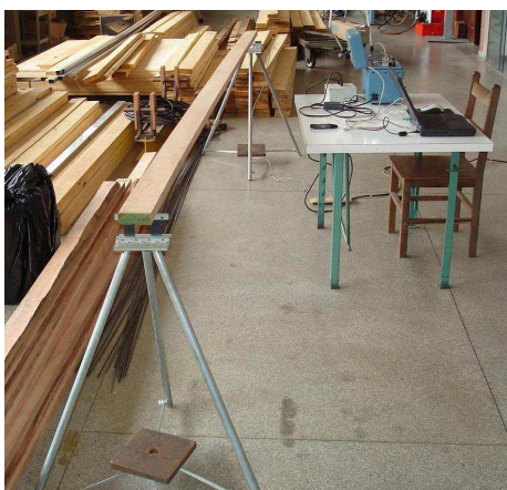
Figura 3.3 – Ensaio por meio de vibração transversal
