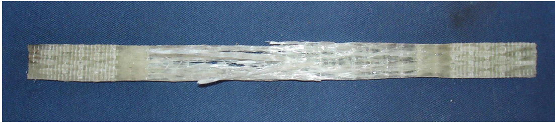
Figura 3.17 – Detalhe típico de ruptura dos corpos-de-prova
