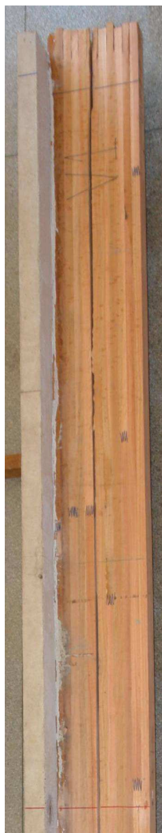
Figura G.5(b) – Ruptura da viga V1: lado direito
