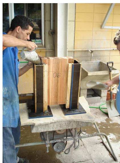
Figura 3.8 – Concretagem dos corpos-de-prova de cisalhamento
