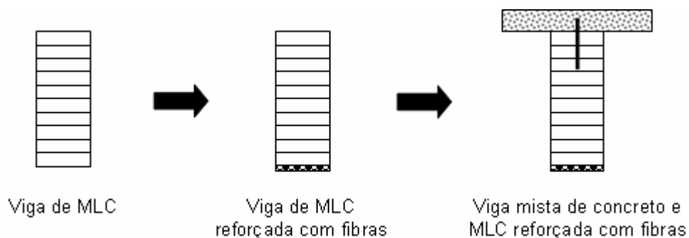
Figura 2.20 – Evolução dos sistemas estruturais para pontes de vigas de madeira. Fonte: Adaptado de Weaver (2002)
