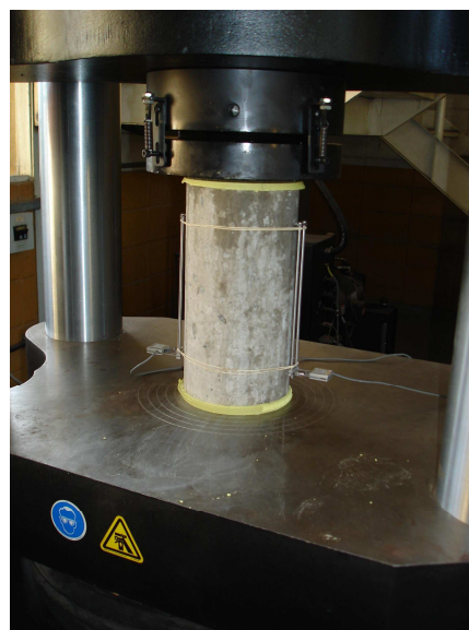
Figura 3.10 – Corpo-de-prova com clip-gages instalados
