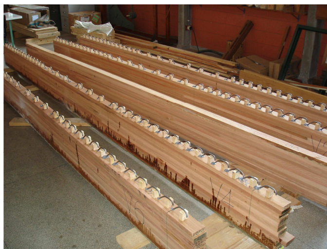
Figura 5.22 – Vigas com ganchos metálicos colados
