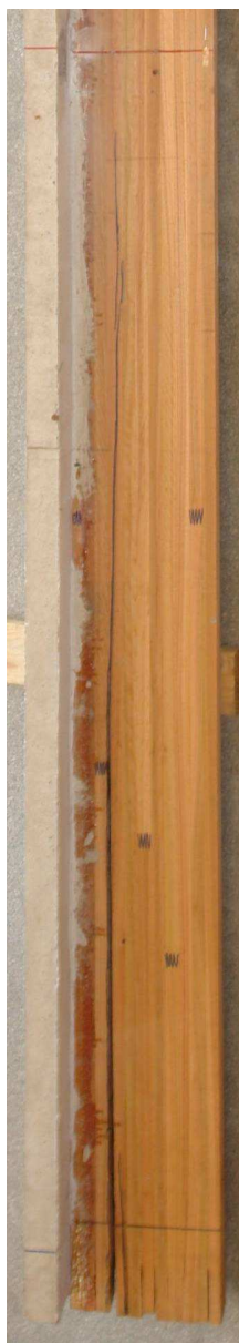
Figura G.6(a) – Ruptura da viga V2: lado esquerdo
