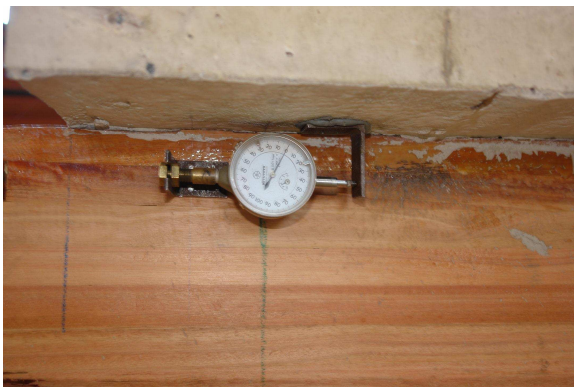
Figura 5.29 – Relógio comparador na interface MLC-concreto
