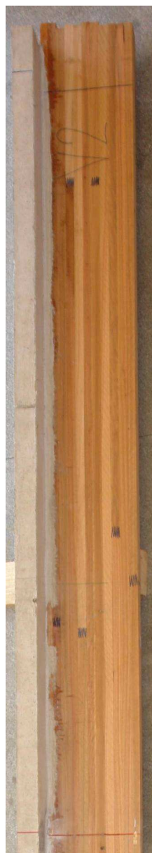
Figura G.6(b) – Ruptura da viga V2: lado direito
