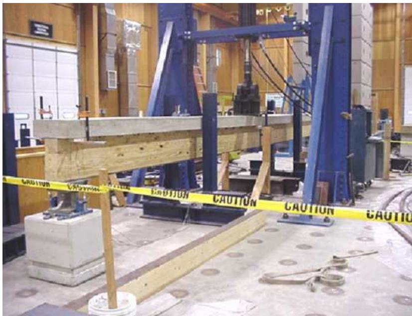
Figura 2.24 – Viga mista de MLC-concreto reforçada com fibras de vidro: arranjo de ensaio. Fonte: Weaver (2002)
