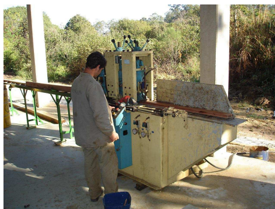
Figura 3.6 – Colagem das emendas dentadas
