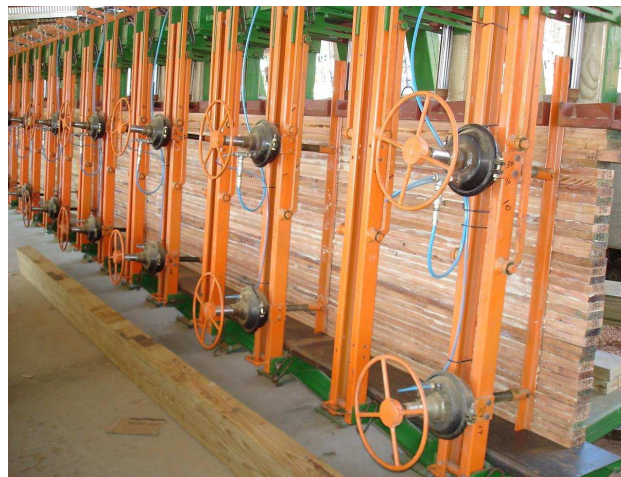
Figura 5.2 – Prensagem das vigas de MLC
