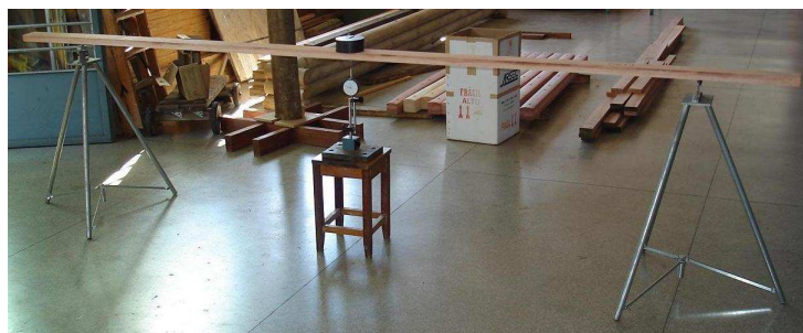
Figura 3.4 – Ensaio por flexão estática
