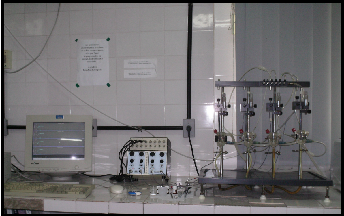
Figura 8 - Aparato utilizado para registros de tensões isométricas em anéis de artéria mesentérica superior isolada de rato.
