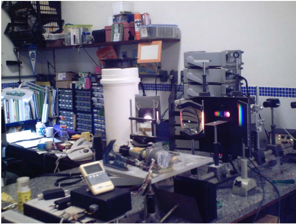
Figura 8. Bancada Fotoacústica para teste de pigmentação.
