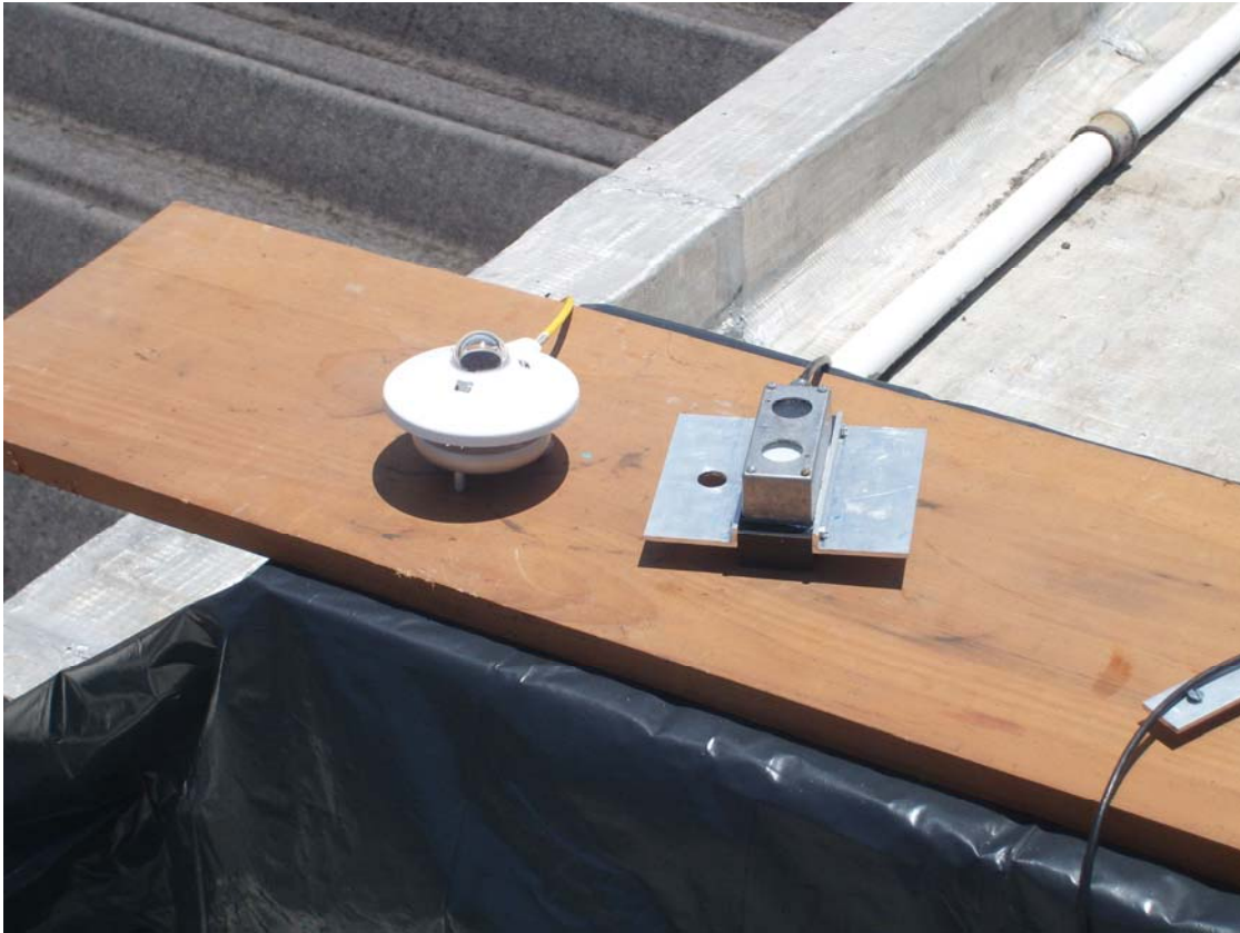
Figura 17. Protótipo e piranômetro Kipp&Zonen expostos ao sol.
