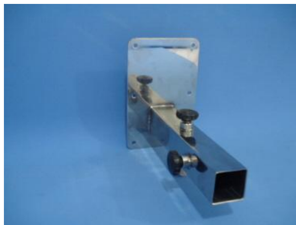
Figura 2 - Placa de aço inox e acoplador com dois manípulos
