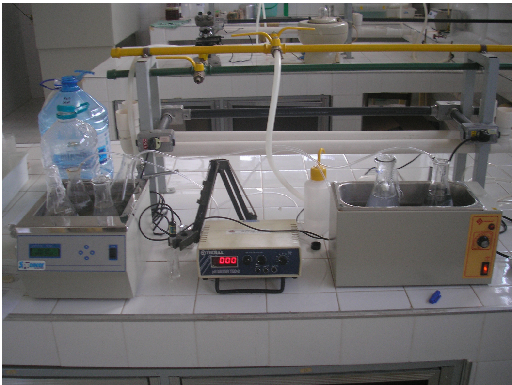
Figura 15 - Ensaios para avaliação do efeito de diferentes concentrações das cargas orgânicas e da aeração no meio, sobre a eficiência de degradação da matéria orgânica.
