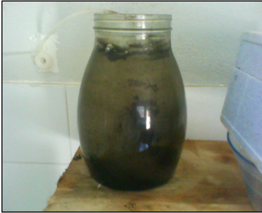
Figura 13 - Lodo ativado previamente condicionado com lactose utilizado para os ensaios de efeito da carga orgânica (planejamento multi-variado) e avaliação das variáveis do SLA (fatorial completo).
