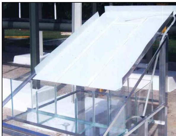
Figura 11 - Reator Solar com placa metálica revestida com TiO 2 .
