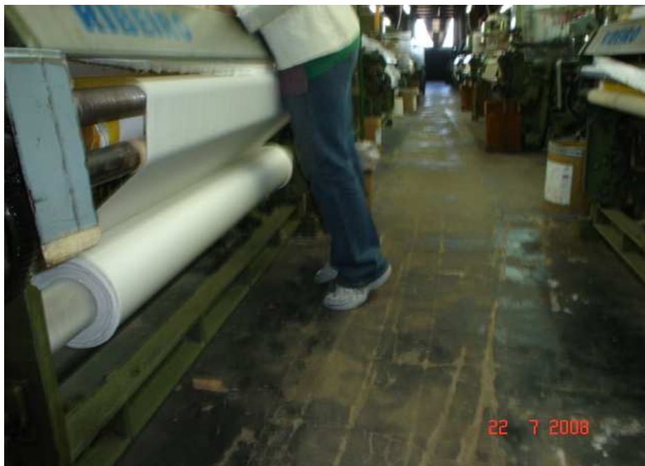
Figura 31 - Posição da funcionária para ter acesso ao fundo do tear.
