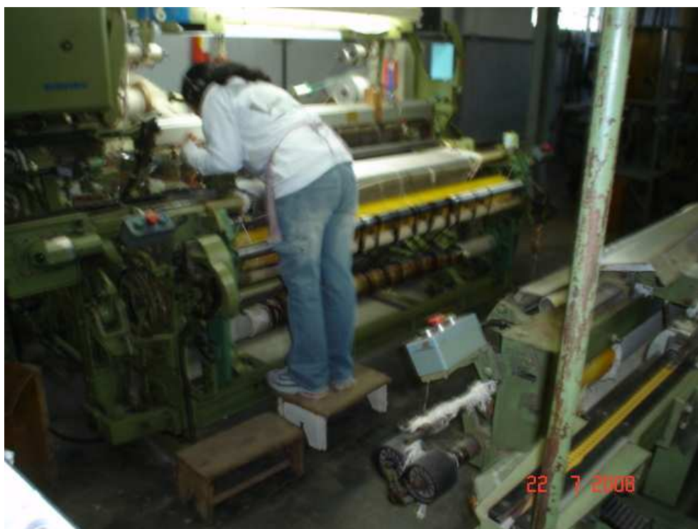
Figura 34 - Utilização do banquinho para acesso ao fundo do tear.
