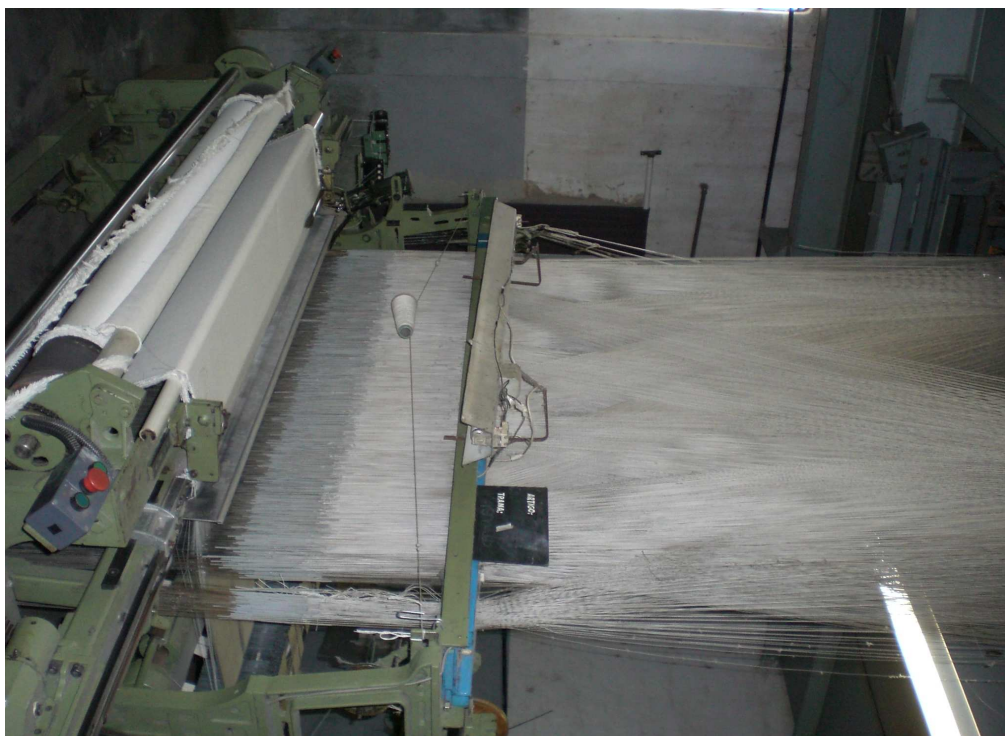
Figura 18 - Vista da entrada da seda no tear.
