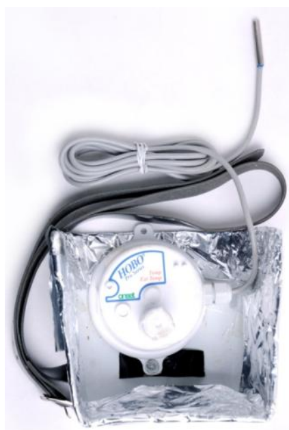
Figura 2.23: Datta-logger dentro da capa protetora
