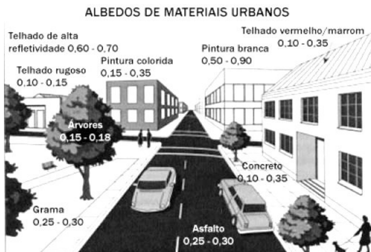
Figura 1.5: Albedo de materiais e superfícies urbanas. Fonte: Espereenc, 2003 apud Barbirato et al (2007).
