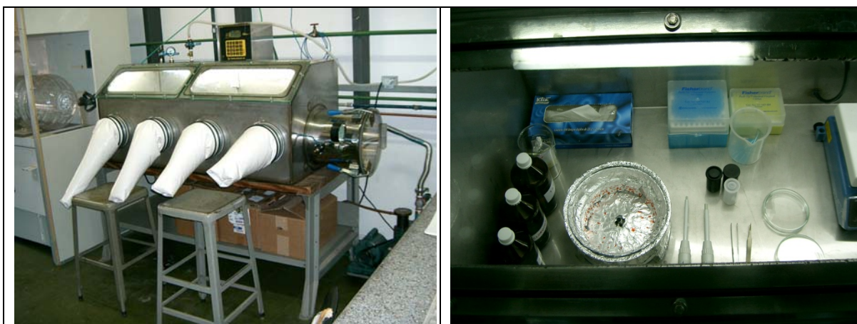
Figura 10: Câmara seca usada no preparo das amostras: (a) visão externa e (b) visão interna.
