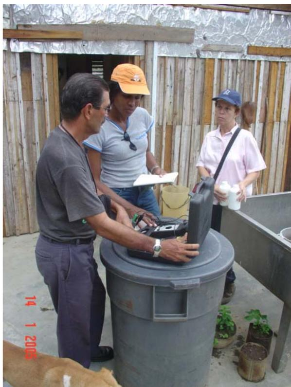
**FIGURA 5B** Coleta de amostra de água e medição dos parâmetros físico-químicos em água da torneira de residência que se abastece do poço S-7 ( $15 \mu\text{g As L}^{-1}$ ).
