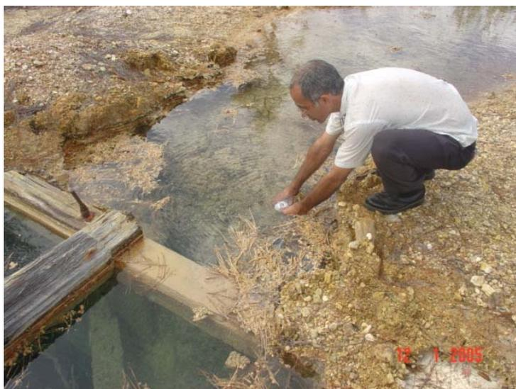
**FIGURA 3B** Nascente das águas subterrâneas ( $44040 \mu\text{g As L}^{-1}$ ) em um dos poços de acesso às galerias da antiga mina Delita (ponto 12). Área de acesso restrito, controlada pela empresa GEOMINERA S.A da Isla de la Juventud.
