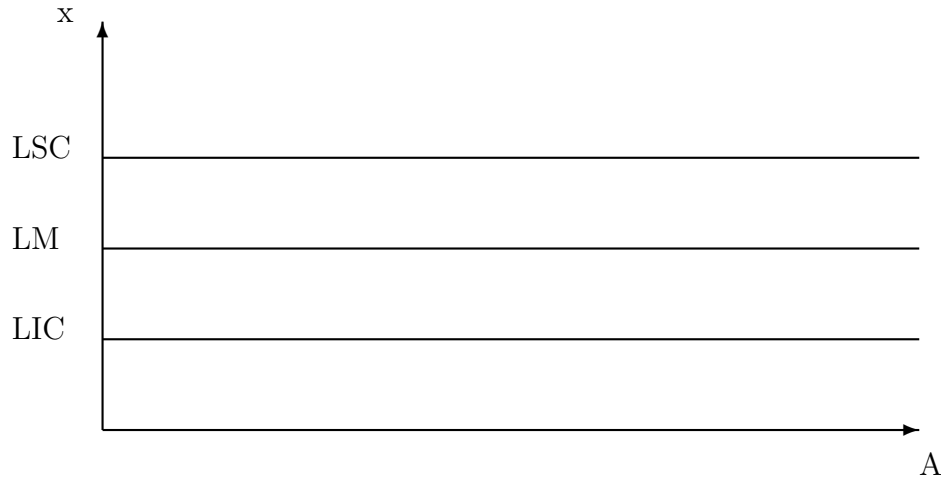
Fig. 1.1 - Estrutura de um Gráfico de Controle
