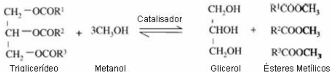
Figura 2 - Esquema da reação de transesterificação do biodiesel. Fonte: MEHER et al. , 2006.
