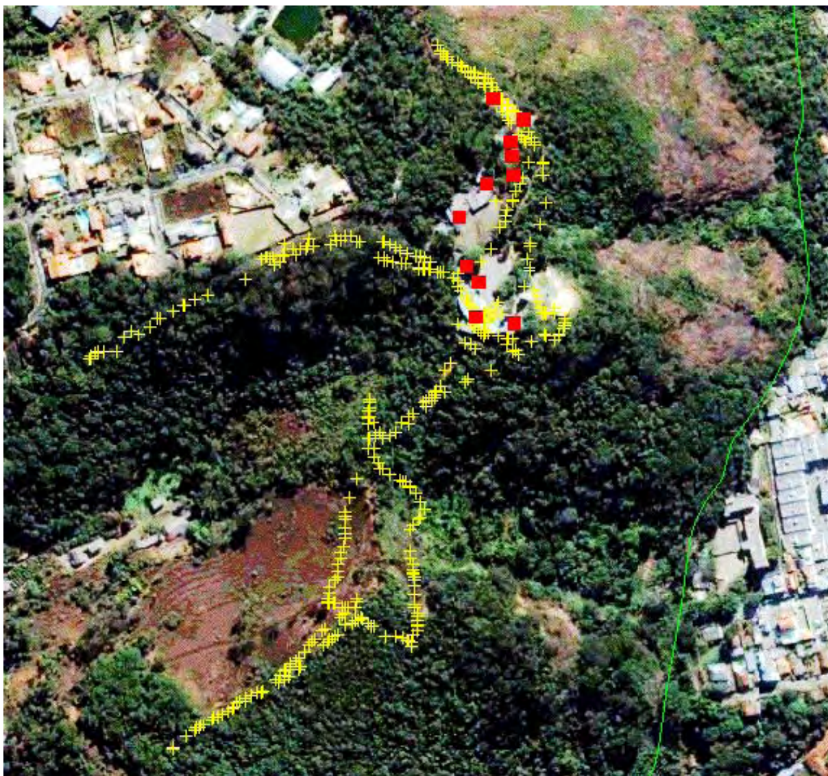
Fig. 25: Pontos obtidos com o GPS - os quadrados vermelhos indicam as antenas.
