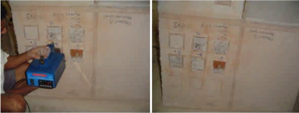
Figura 4.14 – Arrancamento das pastilhas no teste de Resistência de Aderência a Tração das Argamassas.
