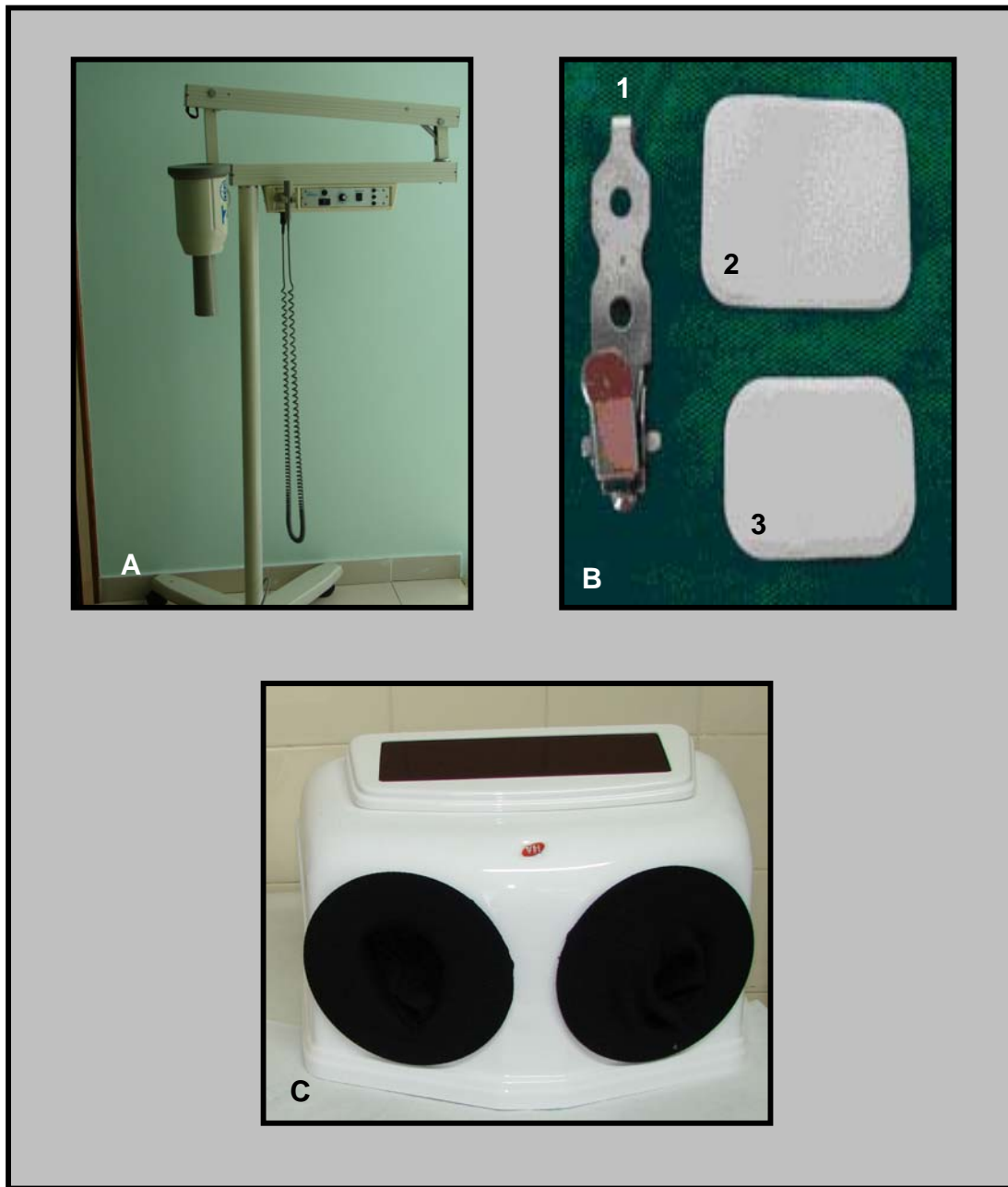
Figura 07 : Materiais para exame de radiologia odontológica A –Aparelho de radiologia odontológica marca Gnatus® modelo XR6010; B-1 : Colgadura para filmes odontológicos; B-2 : Filmes intra-oral Kodak® número 2 e B-3 : Filme intra-oral Kodak® número 0 e C - Câmara Escura VH®.
