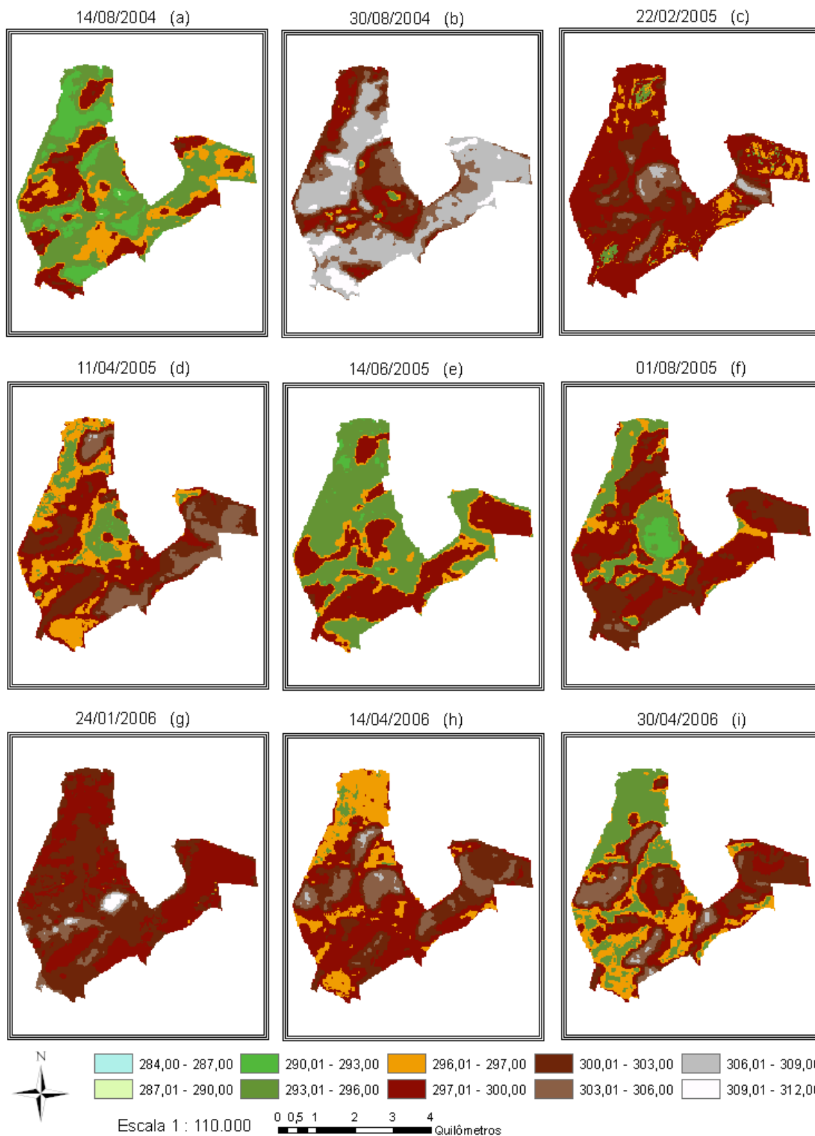
Figura 32 - Temperatura (kelvin) da superfície territorial da fazenda Boa Fé, obtido por meio de imagens do sensor TM do Landsat 5 para as datas: (a) 14/08/2004, (b) 30/08/2004, (c) 22/02/2005, (d) 11/04/2005, (e) 14/06/2005, (f) 01/08/2005, (g) 24/01/2006, (h) 14/04/2006, (i) 30/04/2006.
