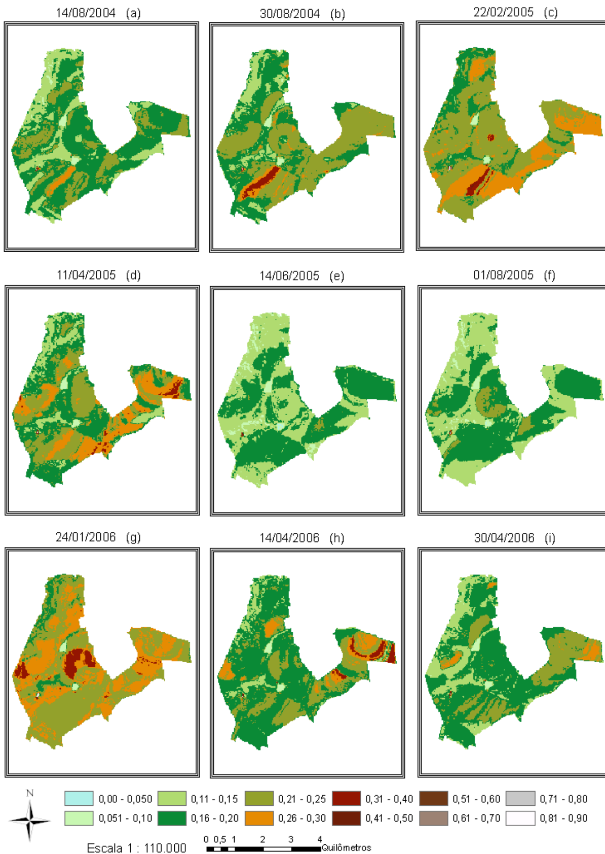
Figura 28 - Albedo da superfície territorial da fazenda Boa Fé, obtido por meio de imagens do sensor TM do Landsat 5 para as datas: (a) 14/08/2004, (b) 30/08/2004, (c) 22/02/2005, (d) 11/04/2005, (e) 14/06/2005, (f) 01/08/2005, (g) 24/01/2006, (h) 14/04/2006, (i) 30/04/2006.
