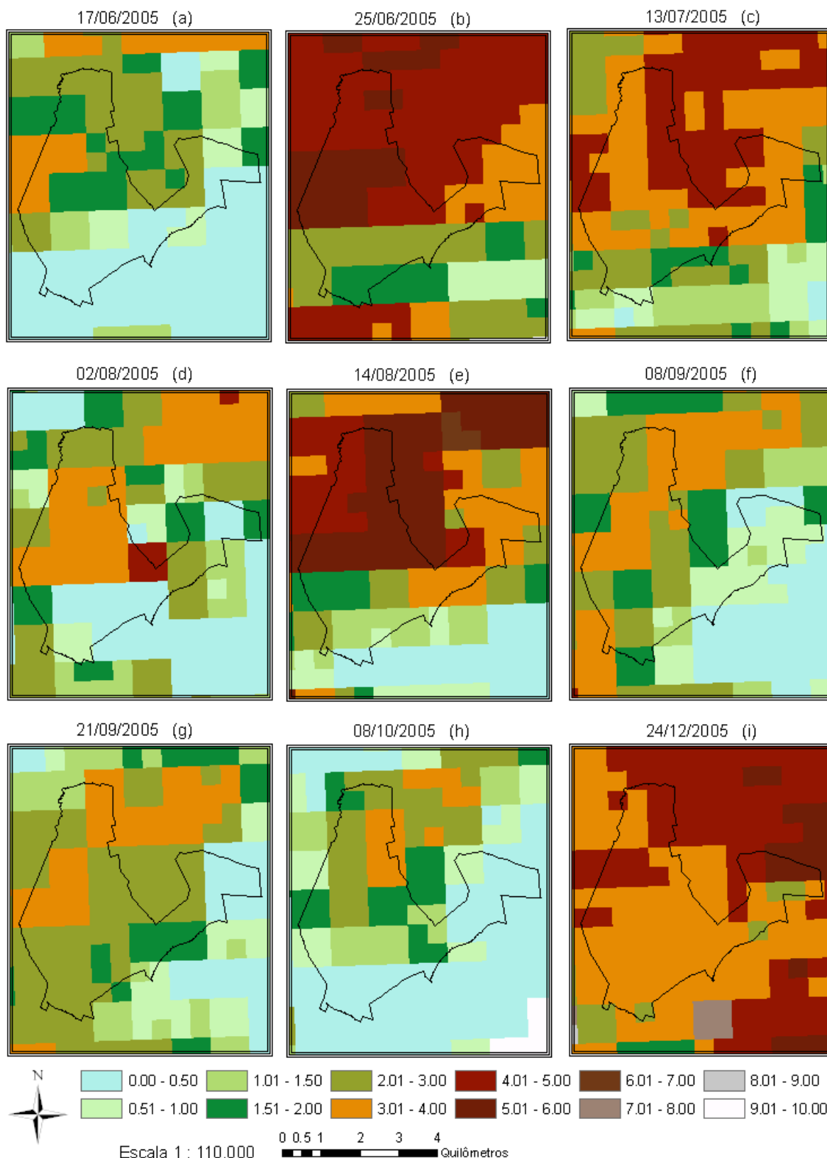
Figura 67 - Evapotranspiração diária ( \text{mm d}^{-1} ) da superfície territorial da fazenda Boa Fé, obtido por meio de imagens do sensor MODIS-Terra para as datas: (a) 17/06/2005, (b) 25/06/2005, (c) 13/07/2005, (d) 02/08/2005, (e) 14/08/2005, (f) 08/09/2005, (g) 21/09/2005, (h) 08/10/2005, (i) 24/12/2005.
