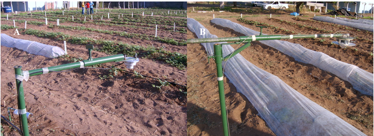
Figura 2. Sensores para captação da radiação refletida (1m acima da superfície) sem agrotêxtil (A) de células de silício e com agrotêxtil (B) do tipo Eppley.
