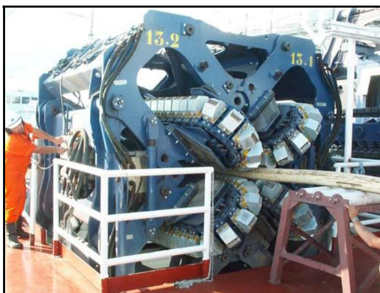
Figura 2.8 Foto ilustrativa de um tracionador, onde pode ser observado o conjunto de sapatas. (Sousa, 2005)
