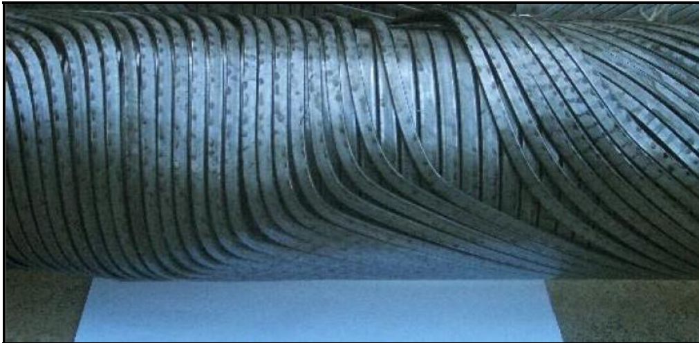
Figura 2.12. Foto de um duto flexível com kevlar em sua composição após sofrer instabilidade por flambagem lateral. (Braga e Kaleff, 2004)
