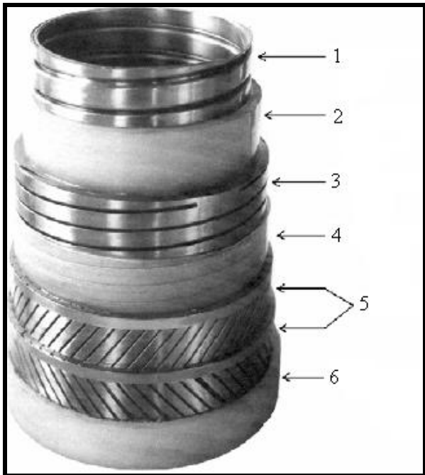
Figura 2.2. Concepção típica de um duto flexível de camadas não-aderentes. (Sousa, 2005)
