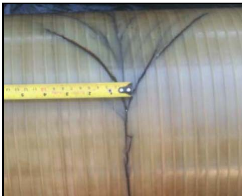
Figura 2.4. Foto da barreira de vedação de um duto flexível danificada após ter suas propriedades alteradas com o processo de envelhecimento. (Almeida et. al., 2005)
