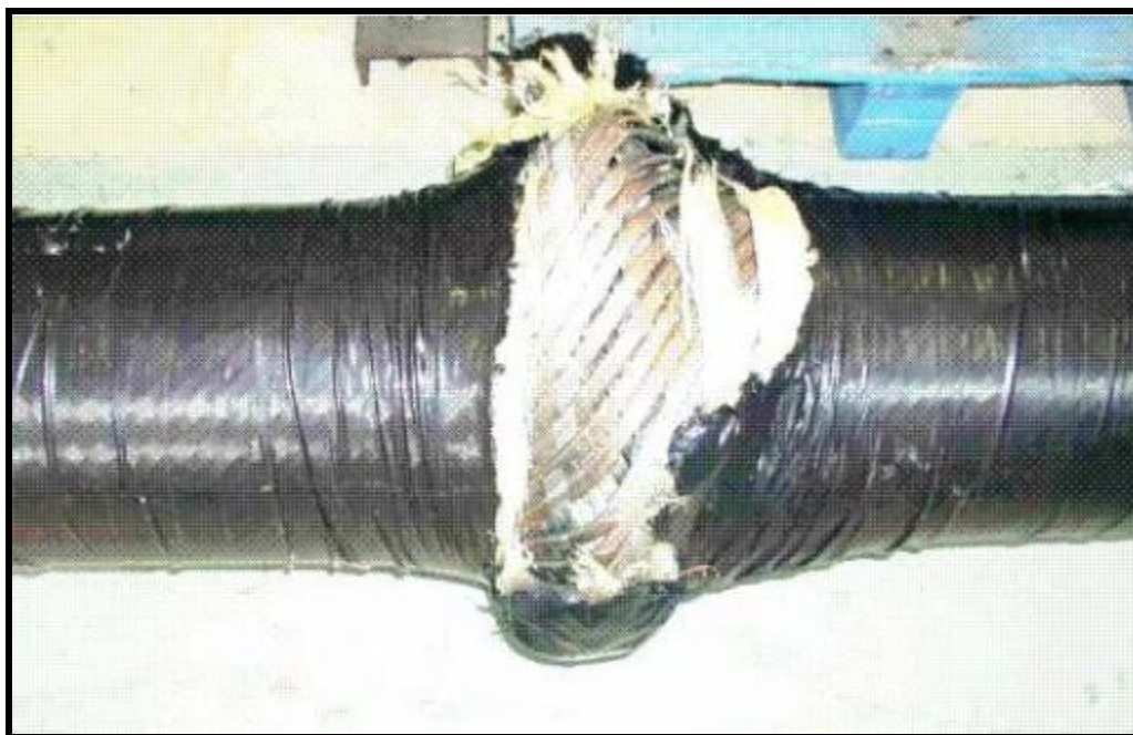
Figura 2.11. Foto de um duto após sofrer instabilidade por gaiola de passarinho.
