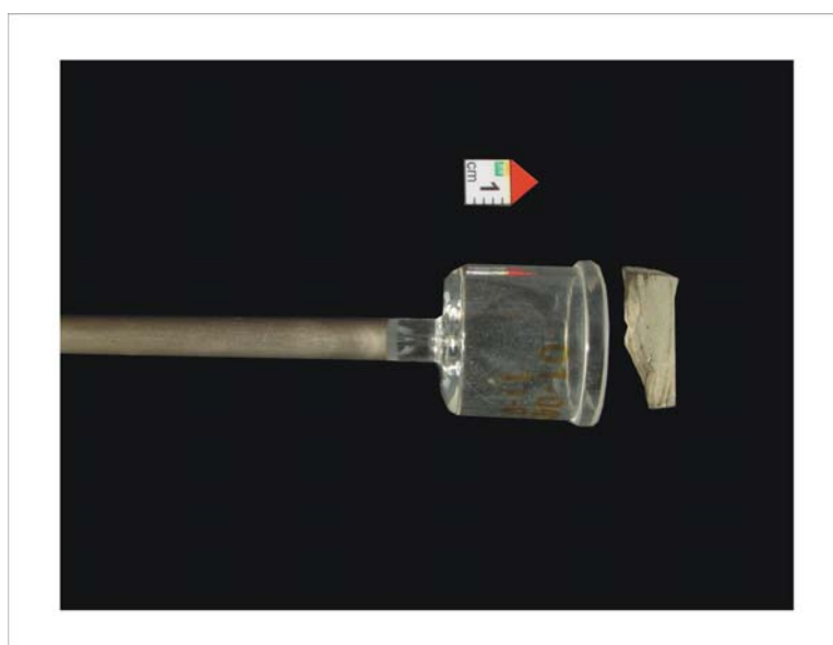
Figura 18 - Fotografia do vaso de intrusão de mercúrio utilizado na capilarimetria por injeção de mercúrio. Notar a pequena dimensão da amostra.
