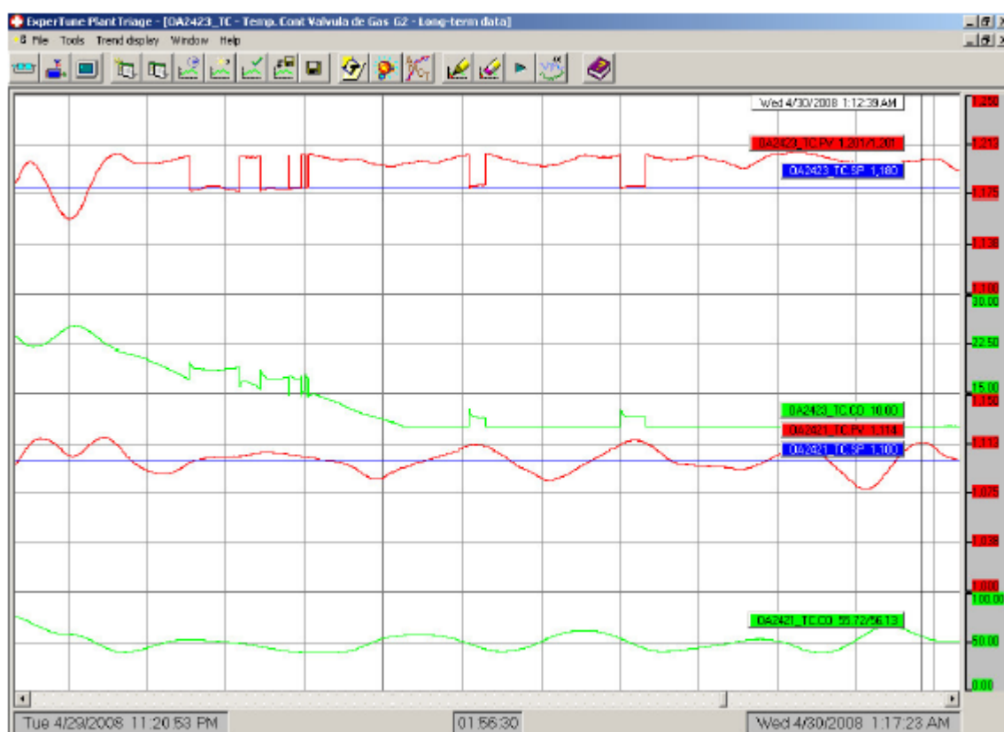
Figura 20 - Descontinuidade na PV para o controlador, devido à exclusão de termopares na média dos grupos.
