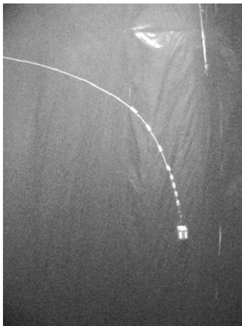
Figura C.12 – Imagem da câmera C3 do lançamento pendular da caixa de acrílico (REF. CAI-C10-D12-F1-LI4-PO0-H2-CG3).
