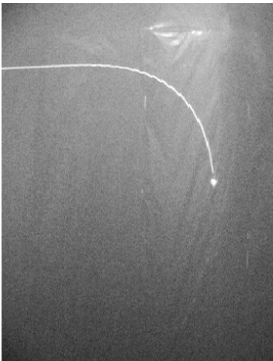
Figura C.5 – Imagem da câmera C3 e câmera C2 do lançamento pendular da esfera (REF. ESF-C25-D12-PO0-H1).
