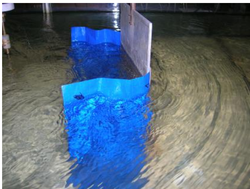
Figura 6.5a – Ensaio da placa de alumínio com lonas laterais.
