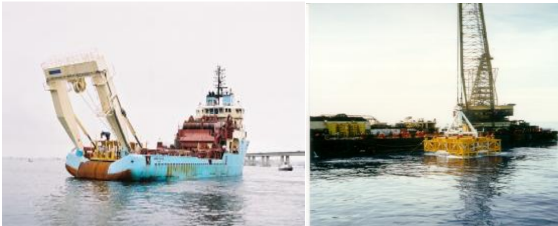
Figura 1.2a – Embarcações utilizadas para a instalação de manifolds via cabo (a) AHTS com A-frame e (b) Balsa guindaste BGL-1.
