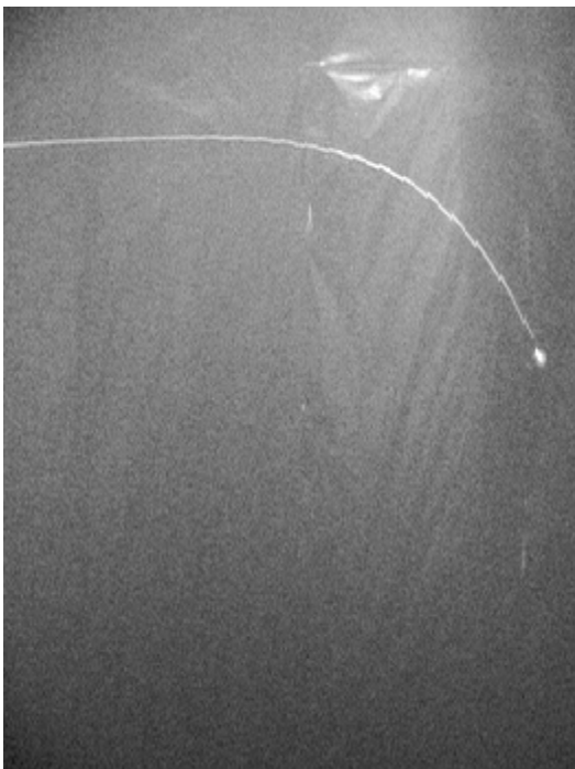
Figura C.3 – Imagem da câmera C3 e câmera 2 C2 do lançamento pendular da esfera (REF. ESF-C10-D12-PO0-H1).
