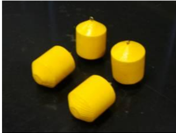
Figura 4.1f – Bombonas com 5 tf de empuxo líquido – escala 1:35.
