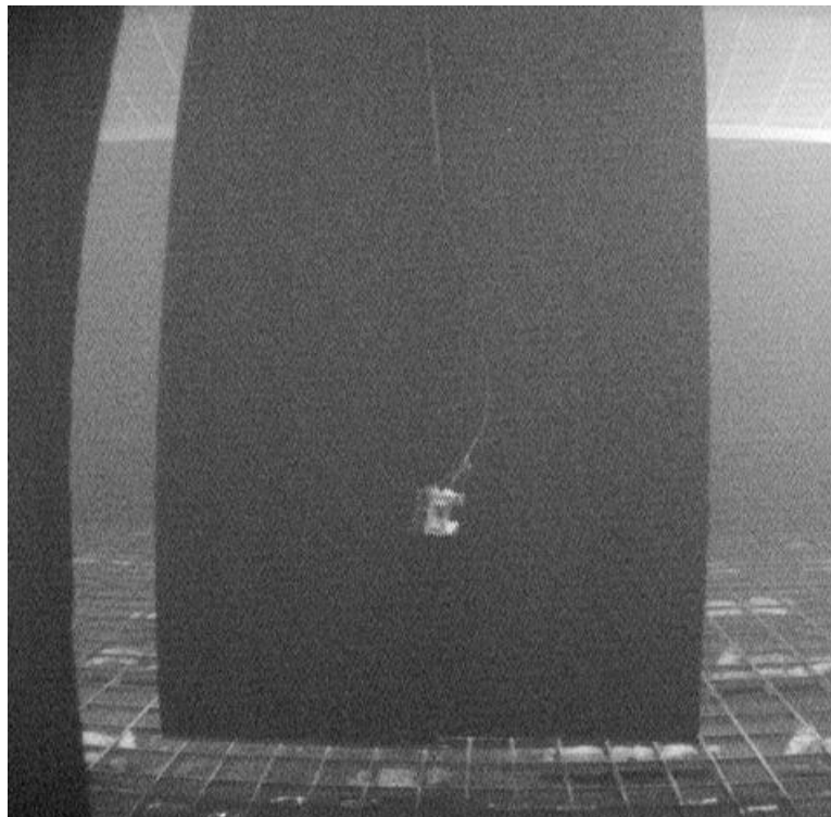
Figura B.7 - Imagem da câmera C4 do lançamento vertical do manifold MSGL-RO-01 no eixo X do modelo (REF. VERT-MSGL-X).
