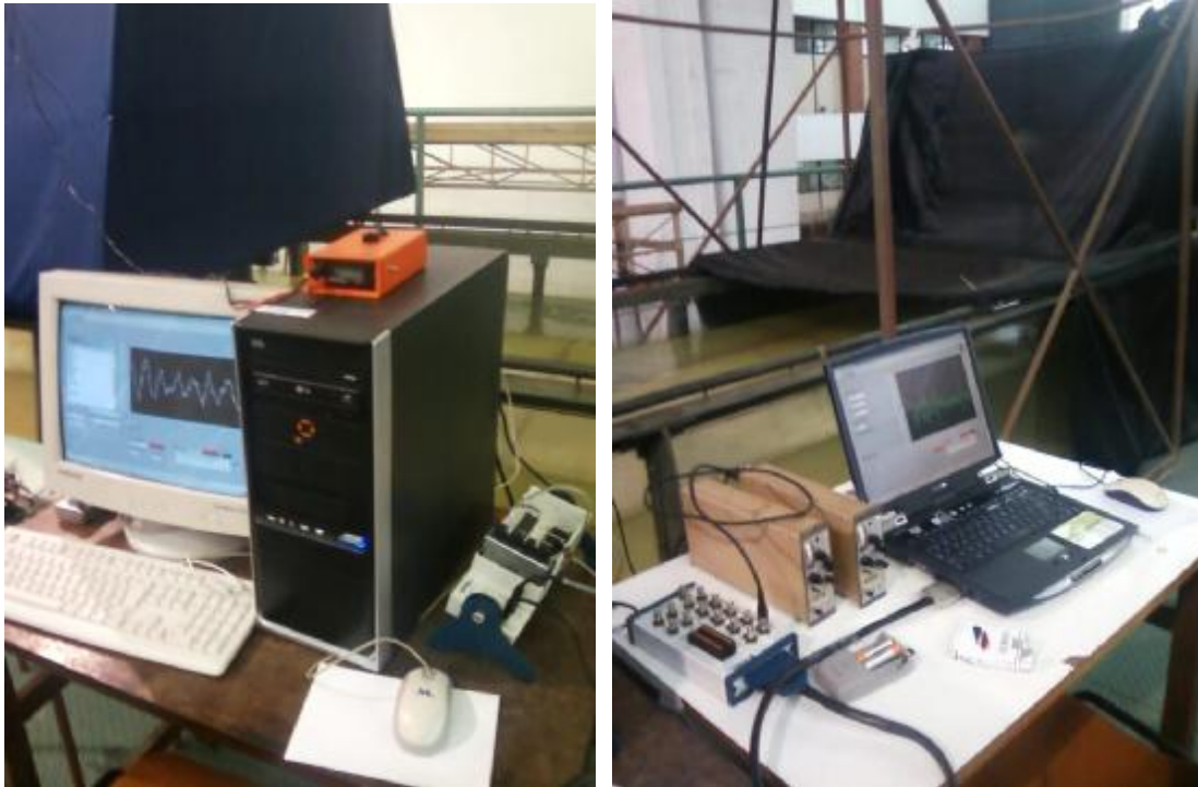
Figura 6.4d – Sistema de aquisição para (a) célula de carga (b) sensor de torque.
