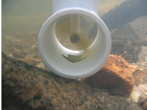
Figura 10: Fluxômetro utilizado na medição da velocidade média da correnteza e velocidade focal, posicionado à frente do “peixe-alvo” em relação ao fluxo da água.
