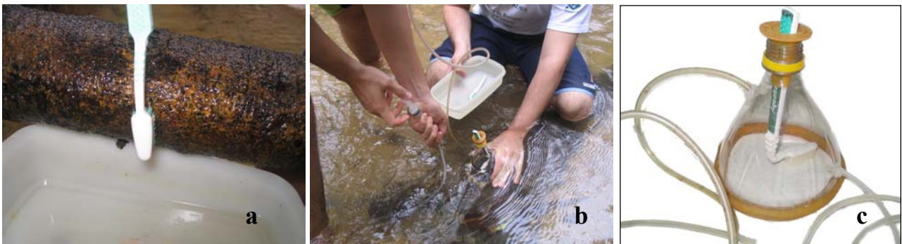
Figura 16: Raspagem do material perifítico em substrato emerso, com escova (a), e submerso, com aparato plástico (b;c).
