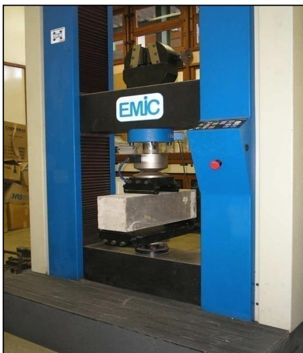
Figura 31 – Ensaio de resistência à tração na flexão.
