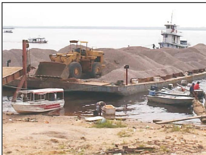
Figura 13 – Balsa transportadora de brita sediada no porto da CEASA.
