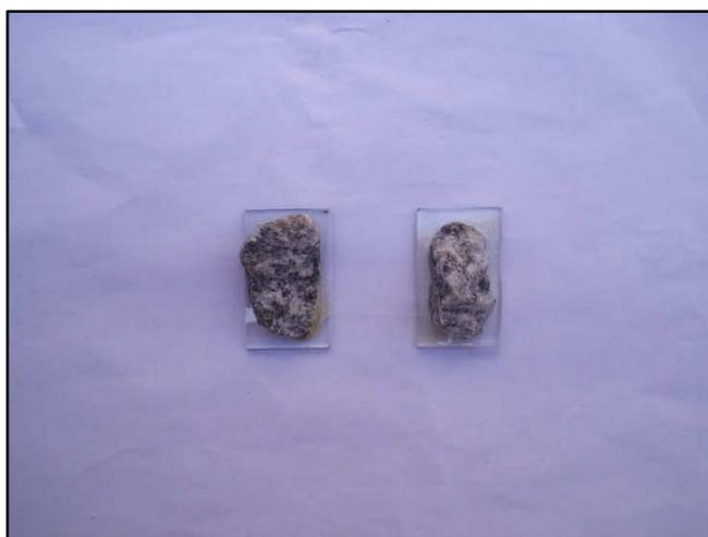
Figura 20 – Fragmentos colados nas lâminas.
