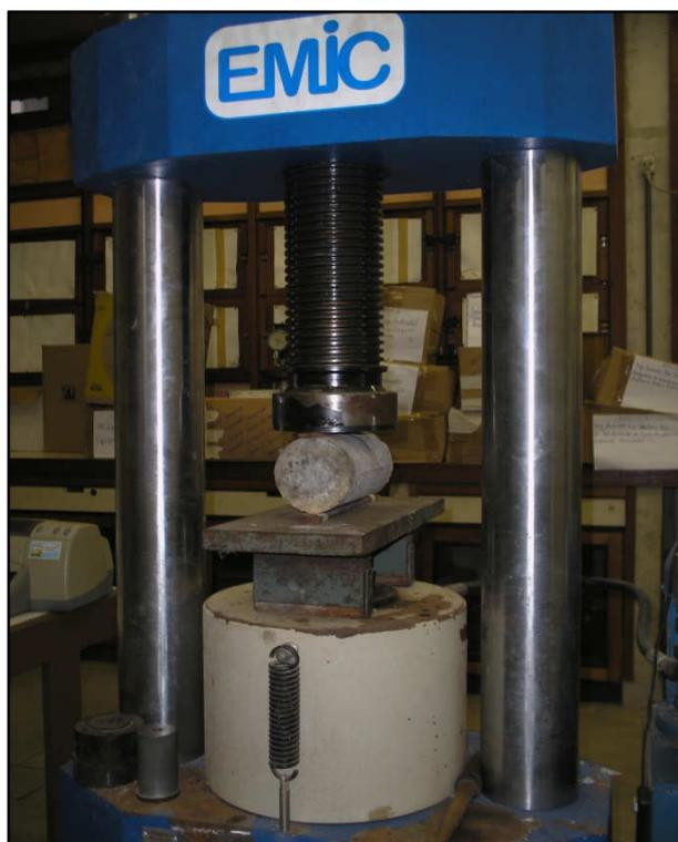
Figura 30 – Ensaio de resistência à tração por compressão diametral.
