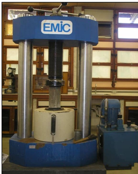
Figura 29 – Ensaio de resistência à compressão axial.
