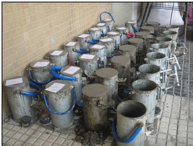
Figura 27 – Corpos-de-prova sendo moldados.
