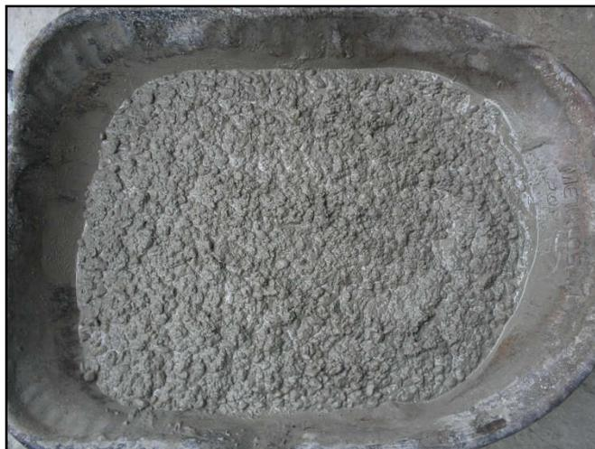
Figura 26 – Concreto para moldagem dos corpos-de-prova.
