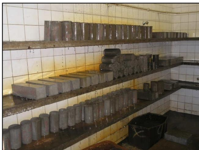
Figura 28 – Corpos-de-prova na câmara úmida.
