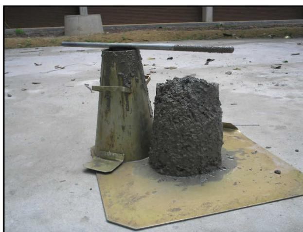
Figura 25 – Determinação da diferença entre a altura do molde e a altura média da amostra.
