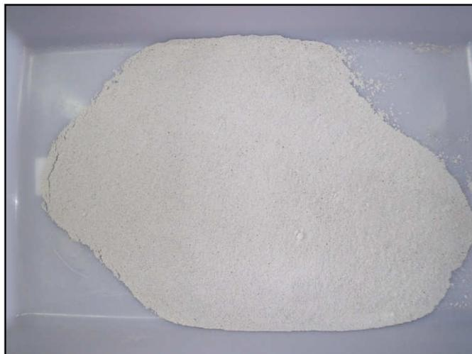
Figura 18 – Amostra de pedra britada pulverizada
