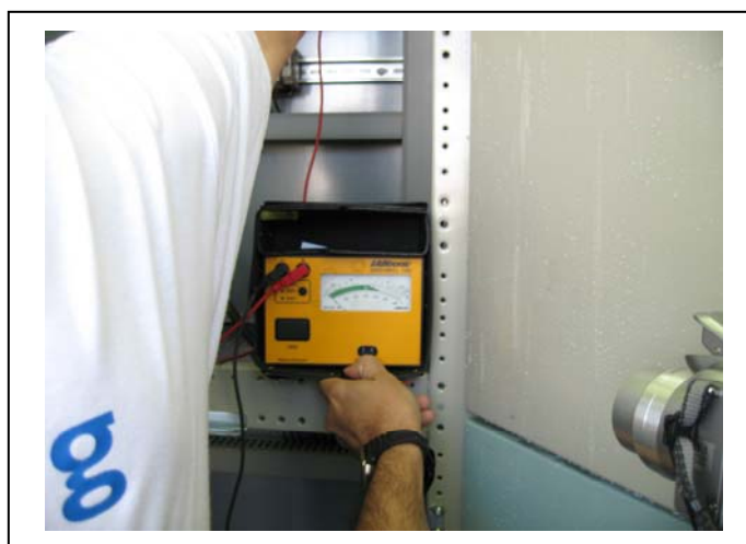
Figura 40 - Teste de Isolação do painel após o teste Fonte: Acervo do autor
