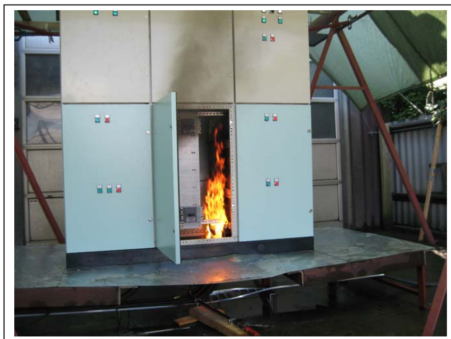
Figura 41 - Combustão nos cabos elétricos Fonte: Acervo do autor
