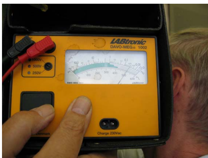
Figura 43 - Teste de isolação Fonte: Acervo do autor
