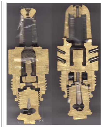
Figura 21 - Vista dos internos do bico aspersor para um fluido de alto rendimento Fonte: Marioff Corporation / SEMCO Maritime
