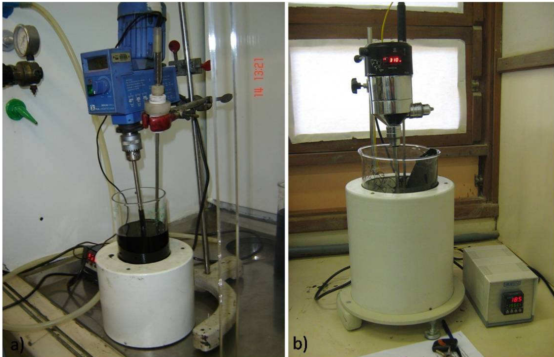
Figura 3.1-6: Misturador: controlador de temperatura, agitador mecânico e manta. Equipamento utilizado para: (a) ensaios de caracterização de ligante realizado no CENPES e (b) confecção das misturas no Laboratório do Grupo de Geotecnia da UFAM
