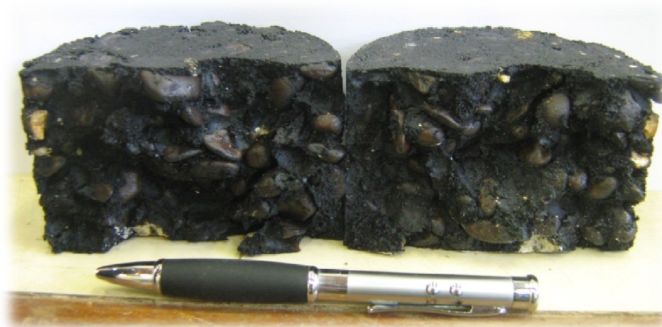
Figura 4.4-1: Corpo-de-prova com agregado graúdo Seixo após ensaio de RT
