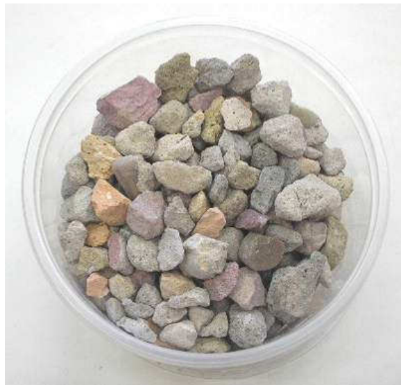
Figura 3.1-4: Agregado Graúdo RCD após reciclagem
