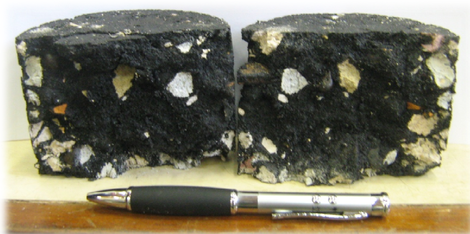
Figura 4.4-2: Corpo-de-prova com agregado graúdo RCD após ensaio de RT
