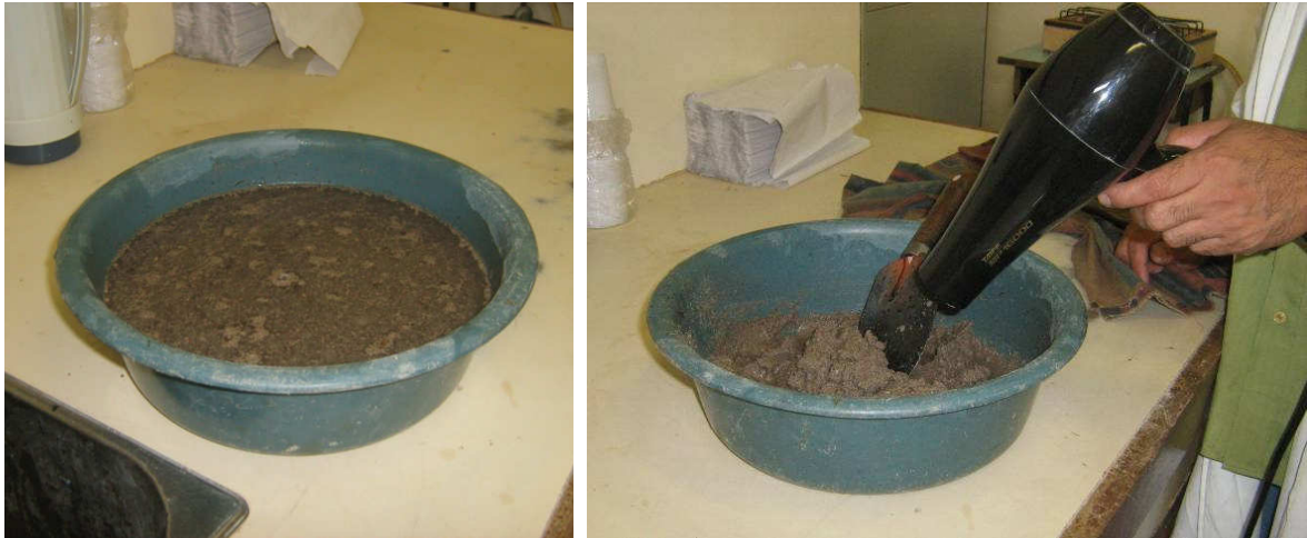
Figura 3.2-14: (a) amostra de areia imersa em água destilada, (b) secagem da amostra
