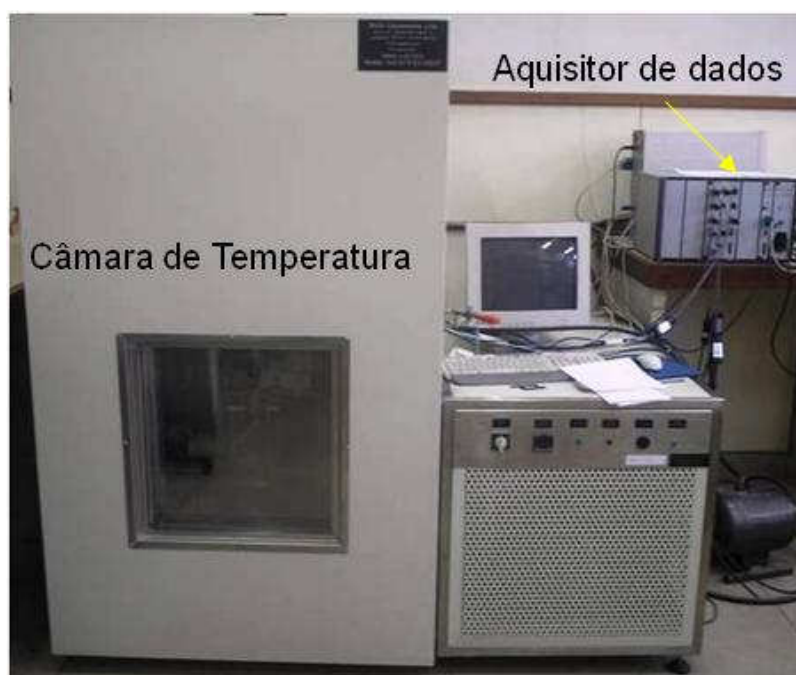
Figura 3.2-21: Vista geral da câmara de temperatura e do aquisitor de dados da UTM
