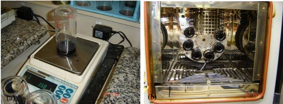
Figura 3.2-5: (a) Recipiente com ligante usado (b) na estufa de fino filme rotativo
