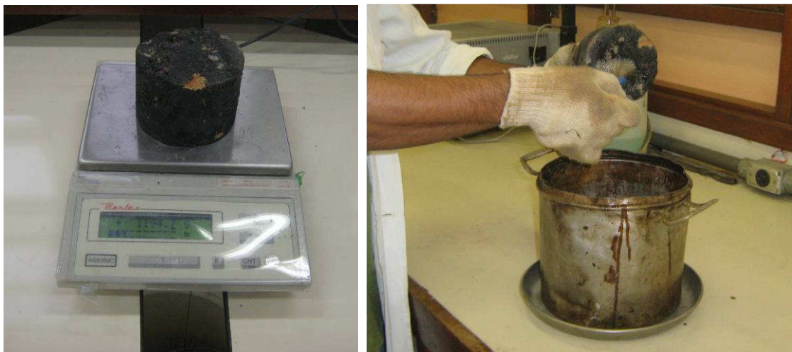
Figura 3.2-17: Densidade relativa da mistura compactada utilizando-se parafina
