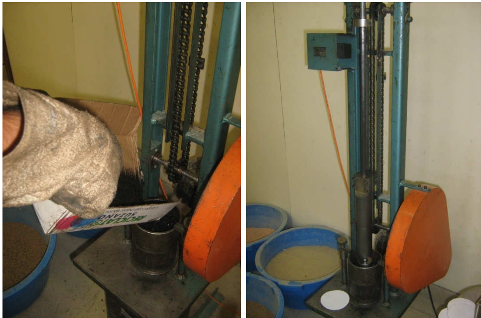
Figura 3.2-20: (a) Despejo da mistura no molde, (b) Compactador Marshall automático
