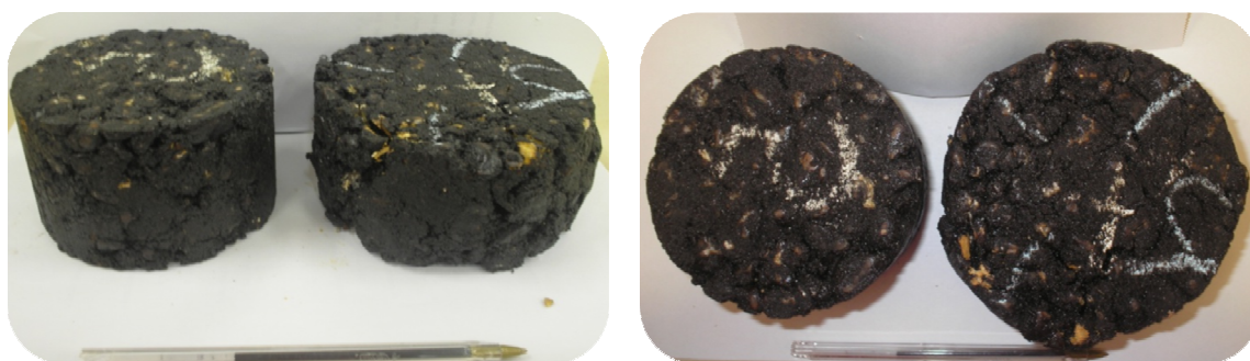
Figura 4.4-3: Corpo-de-prova da mistura SMAN antes e após ensaio de Creep Dinâmico à 64°C
