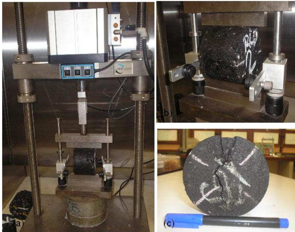
Figura 3.2-23: (a) Vista geral do ensaio RT (b) Posicionamento do CP (c) Corpo-de-prova após ensaio
