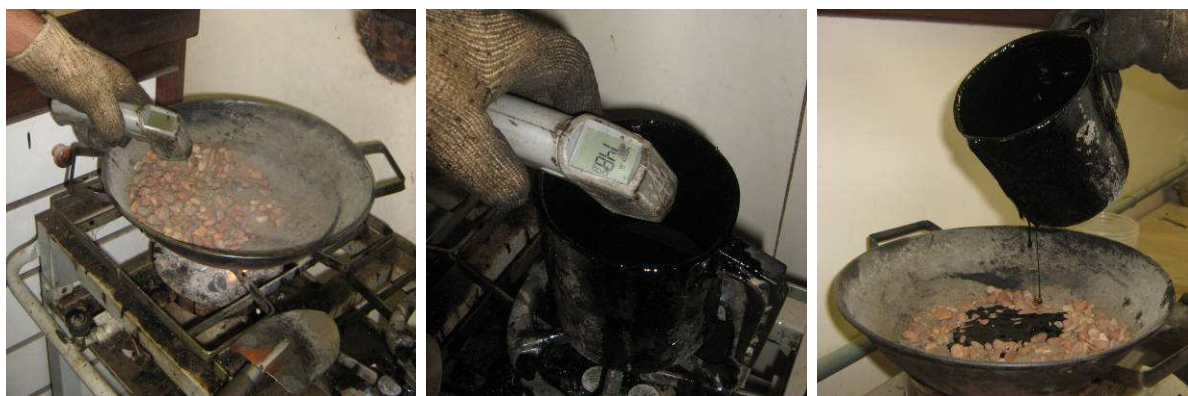
Figura 3.2-19: (a) Aquecimento dos agregados, (b) Aquecimento do ligante, (c) mistura dos componentes
