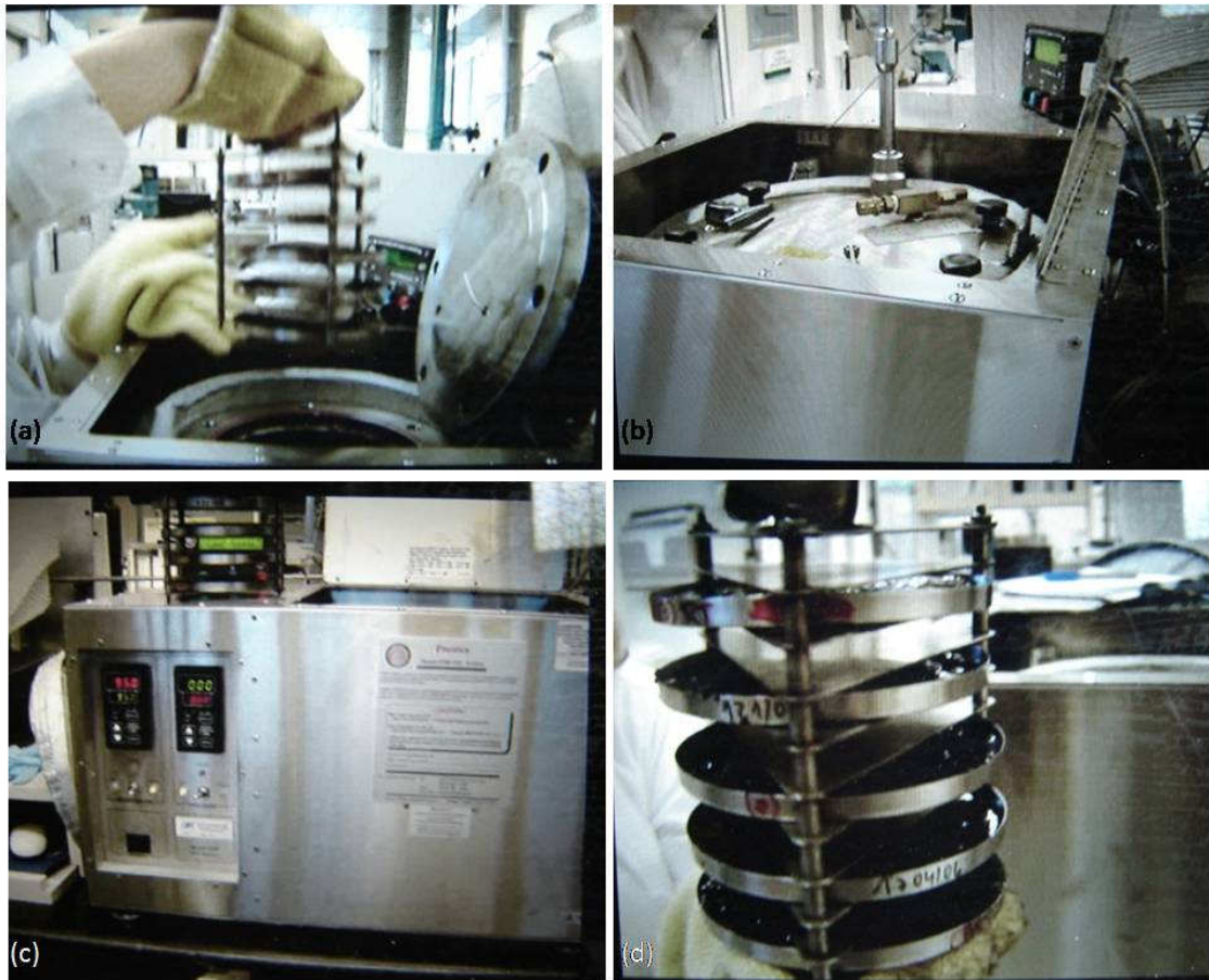
Figura 3.2-6: Ensaio de Envelhecimento PAV: (a) amostra sendo colocada no (b) vaso de pressão, (c) vista frontal e (d) amostra após envelhecimento
