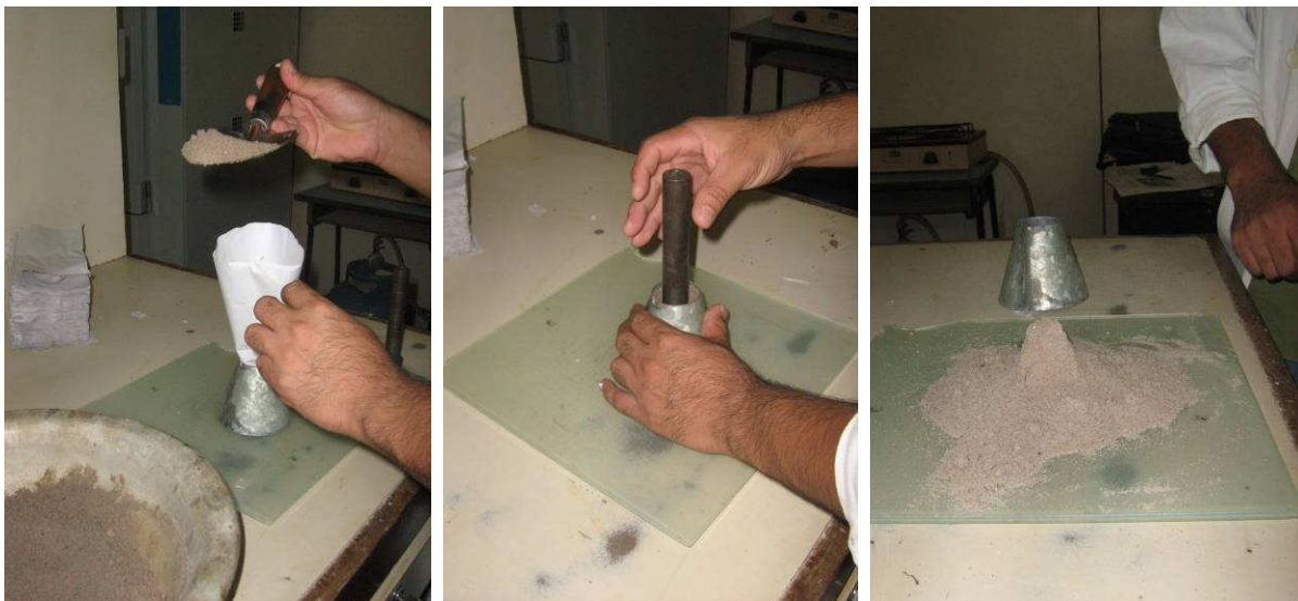
Figura 3.2-15: Teste do cone para verificação da condição saturada superfície seca, no agregado fino
