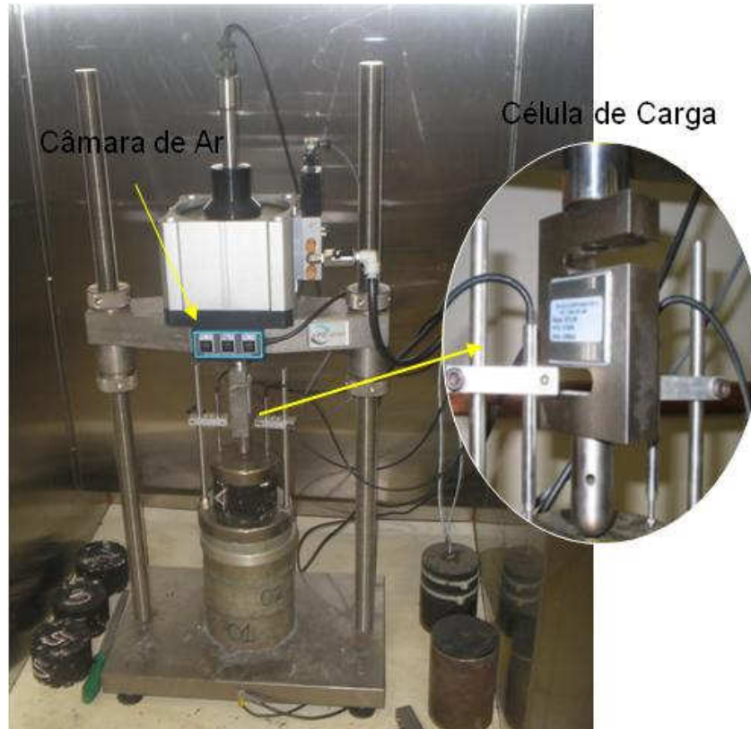
Figura 3.2-22: Vista interna da câmara de temperatura, com detalhe da célula de carga e da câmara de ar da UTM
