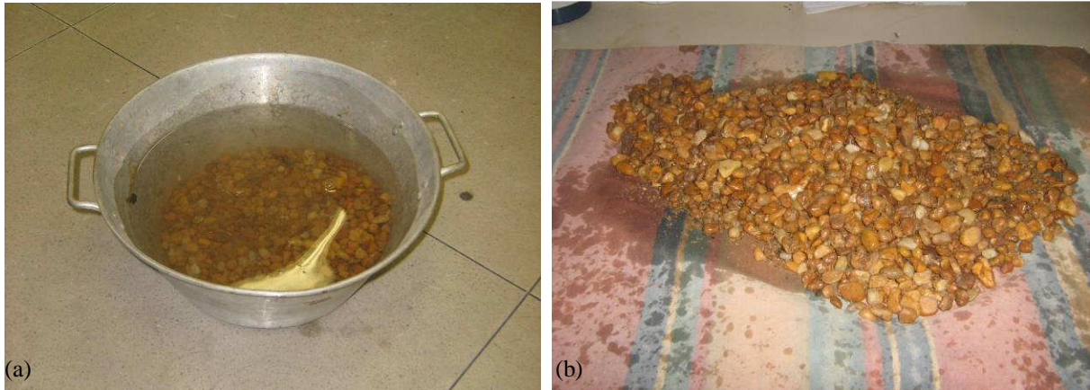
Figura 3.2-13: (a) amostra de seixo imersa em água destilada, (b) secagem da superfície do agregado
