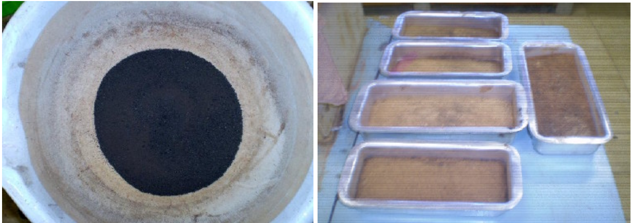
Figura 14 – Lodo destorroado no Mão de Gral; Figura 15 – Lodo calcinado a 300° C (Fotos do autor: Laboratório de Pavimentação da UFAM, 2007).
