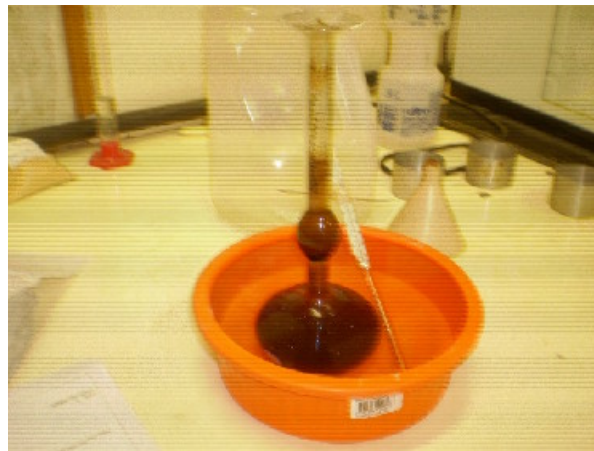
Figura 19 – Ensaio de Le Chatellier com lodo da ETA (Foto do autor: Laboratório de Pavimentação da UFAM, 2007).
