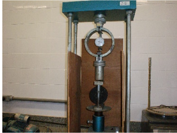
Figura 27 – Etapa do Ensaio de Resistência à Tração (Fotos do autor: Laboratório de Geotecnia na COPPE – UFRJ).
