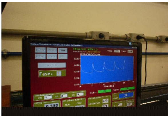
Figura 29 – Exemplos de deslocamentos lidos pelos LVDTs; Figura 30 – Equipamento para realização do ensaio de Módulo de Resiliência (Fotos do autor: Laboratório de Geotecnia na COPPE – UFRJ).
