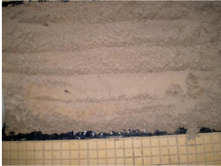
Figura 8 – Agregado miúdo utilizado na presente pesquisa: areia de jazida (Foto do autor: Laboratório de Pavimentação da UFAM, 2007).
