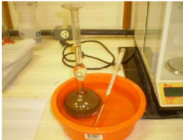
Figura 18 – Ensaio de Le Chatellier para cimento Portland (Foto do autor: Laboratório de Pavimentação da UFAM, 2007).
