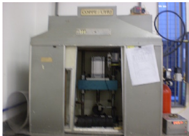
Figura 31 – Câmara de ensaio de MR e Fadiga (Foto do autor: Laboratório de Geotecnia na COPPE – UFRJ).
