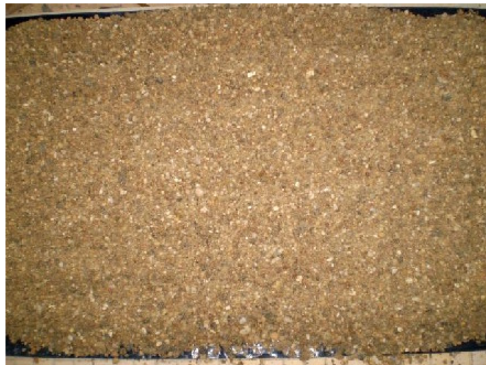
Figura 7 – Agregado graúdo utilizado na presente pesquisa: seixo rolado (Foto do autor: Laboratório de Pavimentação da UFAM, 2007).
