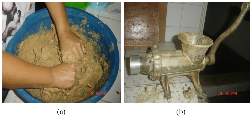
Figura 8 – Processo produtivo do agregado de argila: a) homogeneização; b) moinho para moldagem dos agregados;
