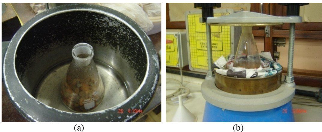
Figura 9 – Etapas do ensaio de desgaste após fervura: a) fervura; b) agitação
