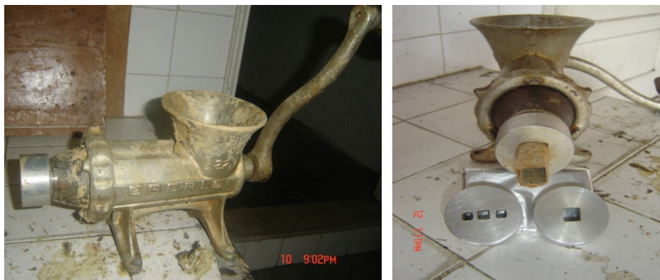
Figura 7 – Moinho para moldagem do agregado de argila
