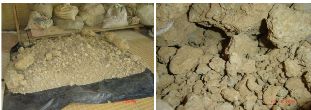
Figura 6- Argila usada para a produção do agregado sintético calcinado
