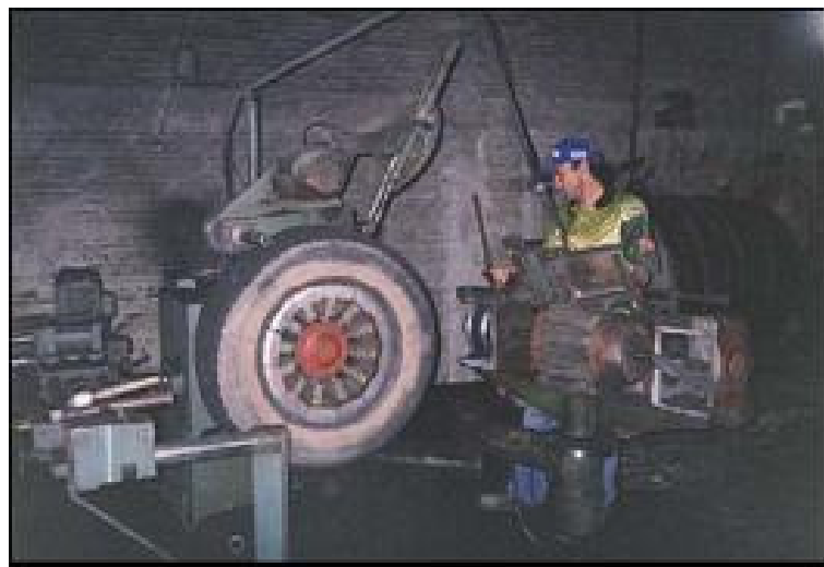
Figura 12: Processo de raspagem da banda de rodagem de pneu para recauchutagem (MACEDO, 2005).
