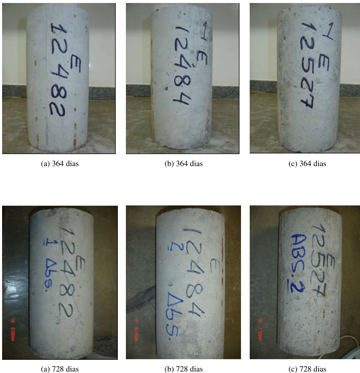
Figura 148: Aspecto geral dos corpos-de-prova aos 364 e 728 dias de idade. (a) Dosagem de referência; (b) Dosagem com substituição de 10% do volume areia por grânulos de borracha de pneu; (c) Dosagem com substituição de 10% do volume areia por fibras de pneu.
