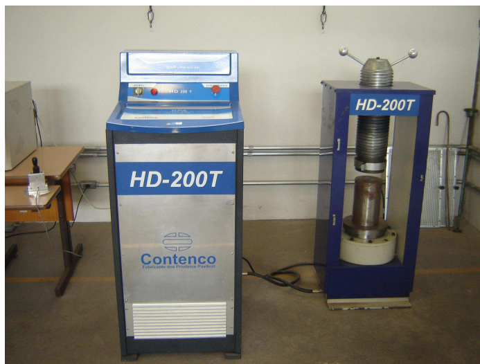
FIGURA 3.18 – Prensa usada para os ensaios de resistência à compressão e tração, localizada no laboratório da CEMIG
