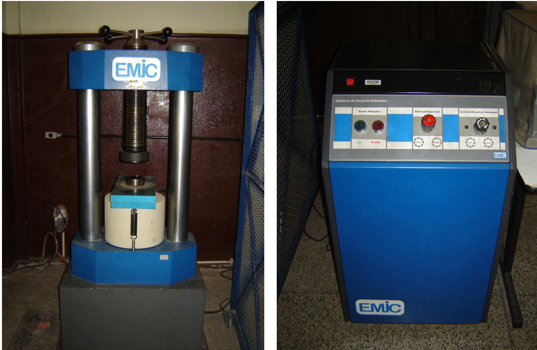
FIGURA 3.20 – (a) Prensa do laboratório de Materiais da UFMG usada para o ensaio de módulo e compressão. (b) Máquina acoplada à prensa, com acionamento da bomba hidráulica
