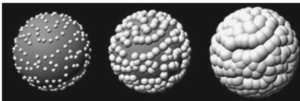
Figura 4.5 - Esquema do processo de crescimento de uma fina camada metálica sobre um núcleo dielétrico.
