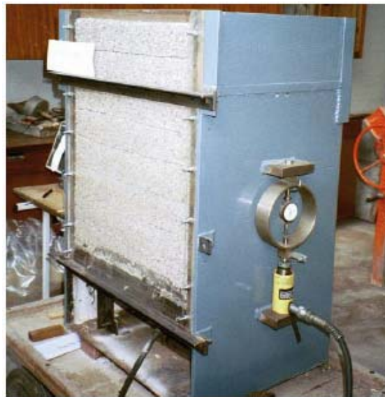
Figura 2.49- Modelo de laboratório construído para estudo do arqueamento (HORGAN & SARSBY, 2002).
