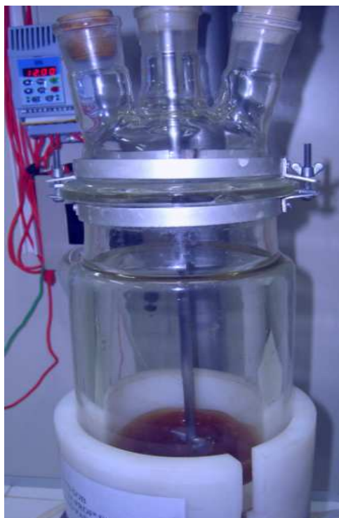
Figura 5.2. Transesterificação do óleo de algodão
