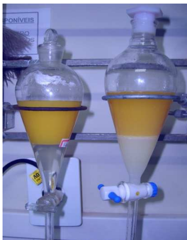
Figura 5.5. Processo de lavagem do biodiesel
