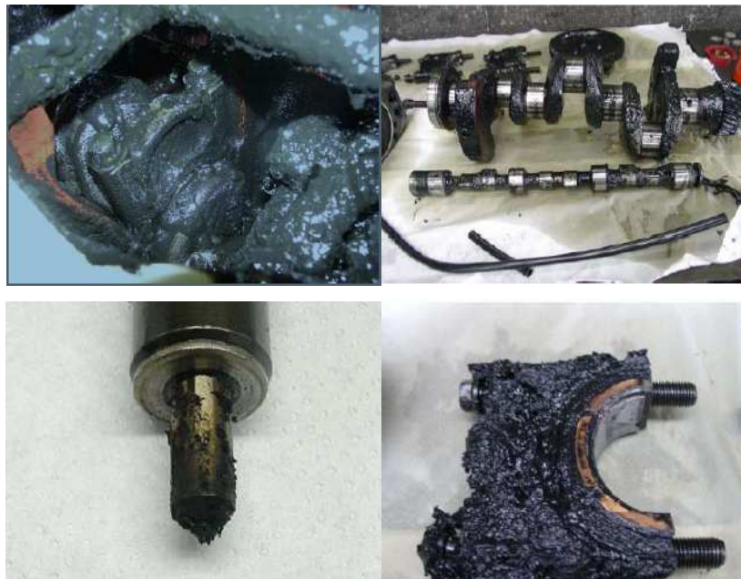
Figura 2.2. Acúmulo de borras no interior do motor e depósito de carvão no bico injetor, observadas com o uso de óleo bruto de girassol.
