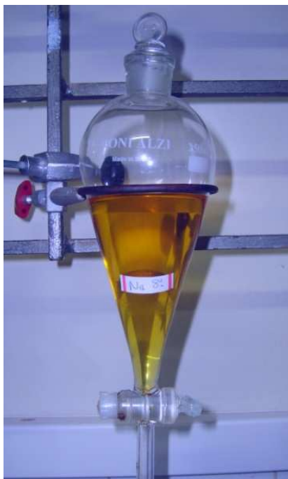
Figura 5.4. Biodiesel metílico de algodão após retirar a glicerina
