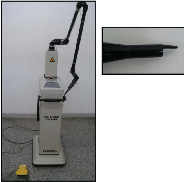
Figura 4.2 – Equipamento de laser de CO 2 e a ponta utilizada para procedimento de irradiação dos espécimes
