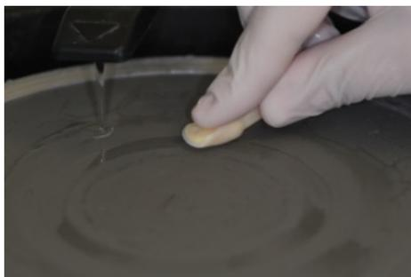
Figura 4.3 – Planificação da superfície
