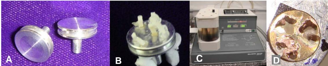
Figura 4.13 – Preparo para microscopia eletrônica de varredura. A: Stubs; B: Fragmentos dos corpos de prova colados no stub; C: Metalizadora; D: Amostras metalizadas.
