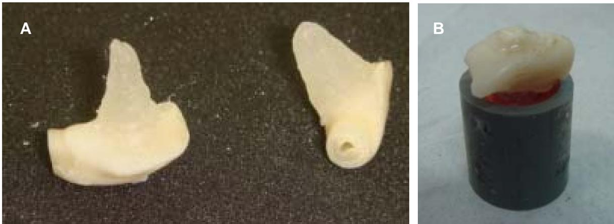
Figura 4.9 - Embutimento das amostras no tubo de PVC. A: Cone de resina acrílica na porção palatina; B: Amostra embutida
