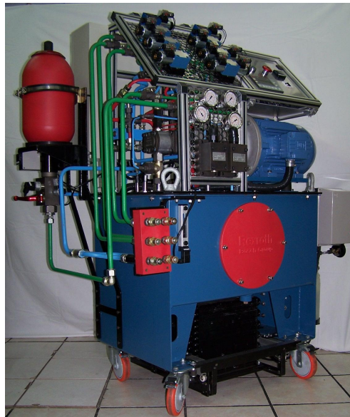
Figura 6.1 – UPCH – Unidade de potência e condicionamento hidráulica
