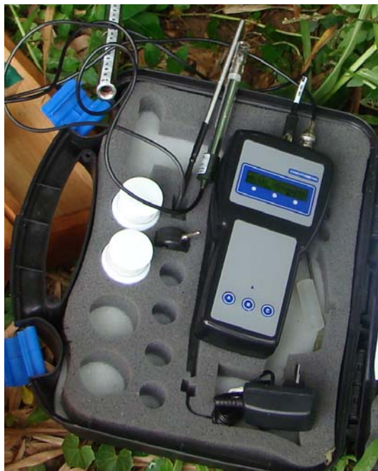
Figura 5.5 – Condutivímetro usado no teste de campo.
