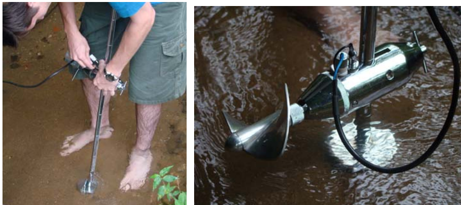
Figura 5.3 – Foto com a utilização do molinete na seção de injeção (SILVA, 2009)
