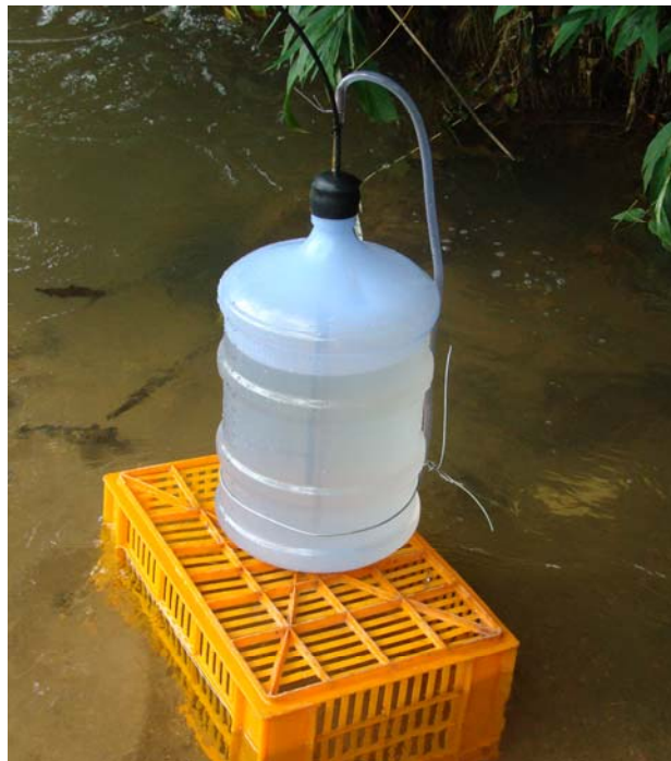
Figura 5.4 – Vaso de Mariotte utilizado na determinação da vazão pelo método químico (SILVA, 2009)
