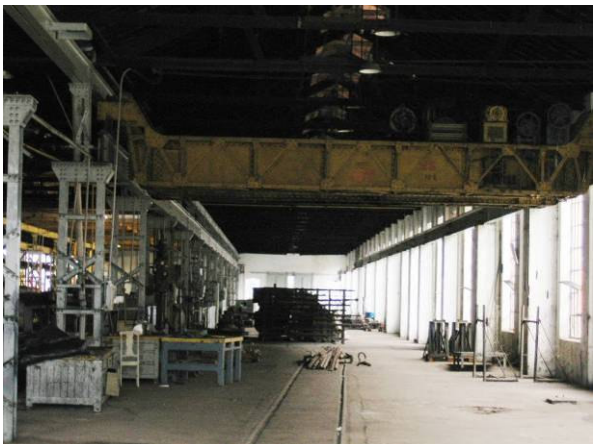
Na Fig. 88 vemos a situação atual da porção da seção de locomotivas originalmente ocupada pela caldeiraria . Já a Fig. 89 nos mostra detalhe do guindaste rodante elétrico para 10 toneladas. Fotos da autora (2007).
