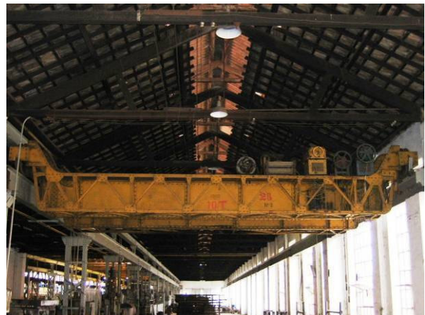
Na Fig. 88 vemos a situação atual da porção da seção de locomotivas originalmente ocupada pela caldeiraria . Já a Fig. 89 nos mostra detalhe do guindaste rodante elétrico para 10 toneladas. Fotos da autora (2007).
