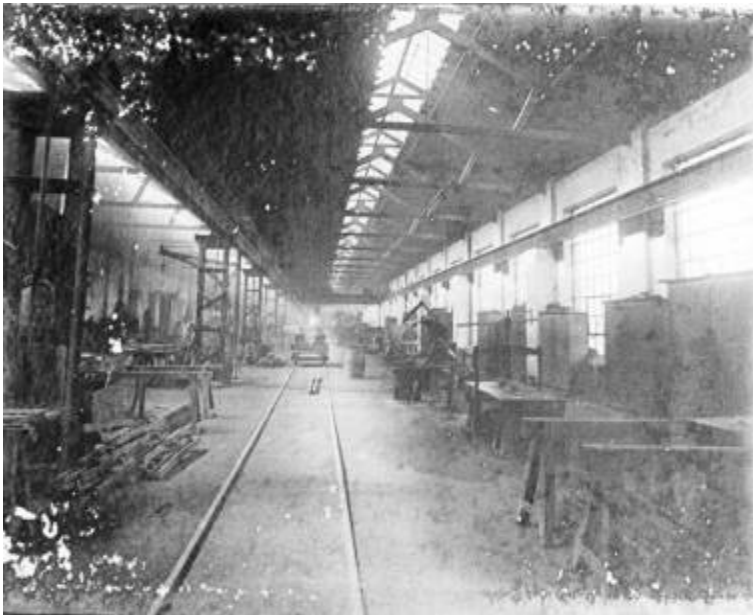
Vista da caldeiraria . Notar na Fig. 87 , ao lado, logo abaixo do telhado, na metade superior da foto, as vigas de sustentação do guindaste elétrico rodante que servia a seção. Acervo do Museu da Companhia Paulista.
