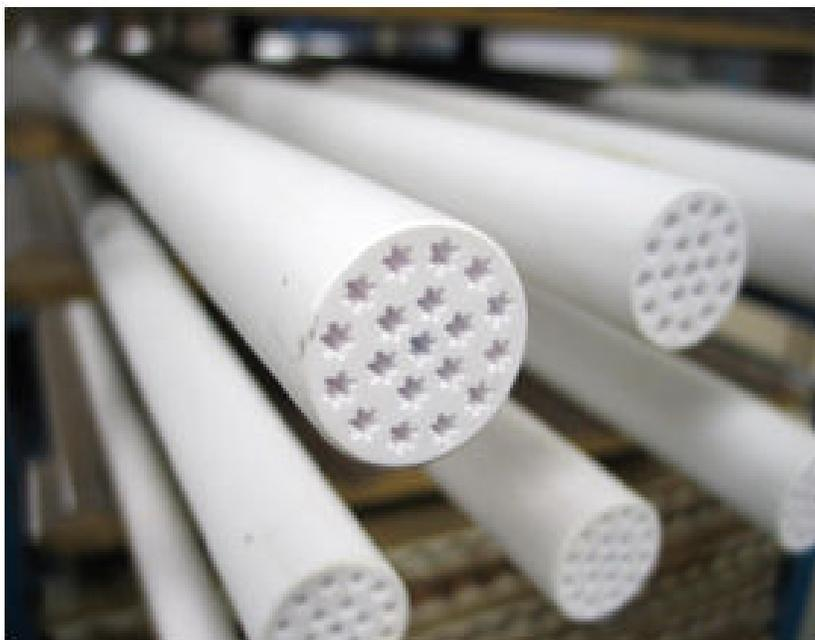
FIGURA 3.1 – MEMBRANA TUBULAR COM CANAIS ESTRELADOS.
