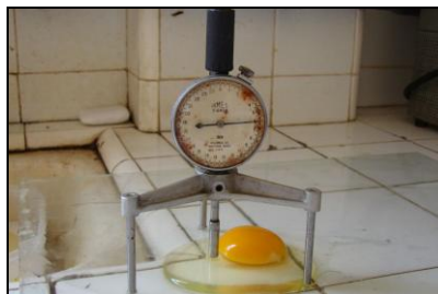
Figura 2. Determinação da altura do albúmen denso com micrômetro tripé Ames modelo S-6428.
