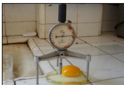
Figura 2. Determinação da altura do albúmen denso com micrômetro tripé Ames modelo S-6428.
