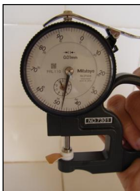
Figura 5. Determinação da espessura da casca com micrômetro analógico de pressão Mytutoyo.
