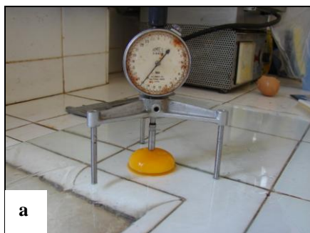
Figura 3. Determinação da altura da gema com micrômetro tripé Ames modelo S-6428 (a) e do diâmetro da gema com paquímetro analógico Mytutoyo (b).
