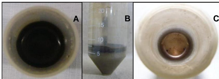
**Figura 4** – Retirada do resíduo dissolvido pelo ácido clorídrico PA: A) Aspecto do material antes da remoção dos resíduos; B) Retirada do material dissolvido com pipeta Pasteur de plástico - observar o “pelet” de espículas no fundo do tubo e C) Aspecto do material após a remoção dos resíduos
