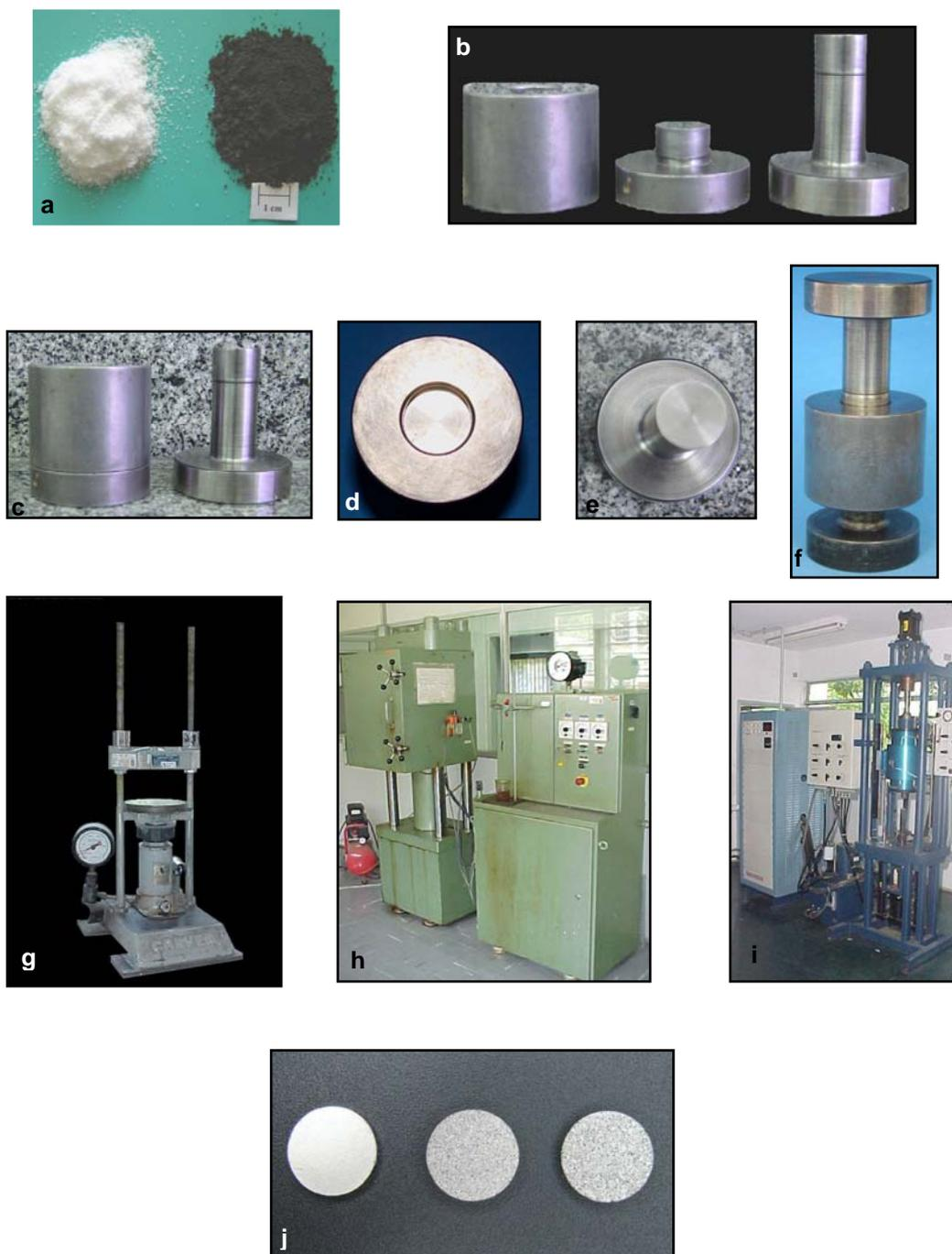
Figura 1 - **Procedimentos de confecção das amostras:** a) pó de titânio e uréia em grânulos; b-f) matriz idealizada para a confecção dos implantes; g) prensa uniaxial; h) prensa isostática; i) forno a vácuo – Thermal Technology, modelo ASTRO; j) amostras com diferentes porosidades (grupos 1, 2 e 3).
