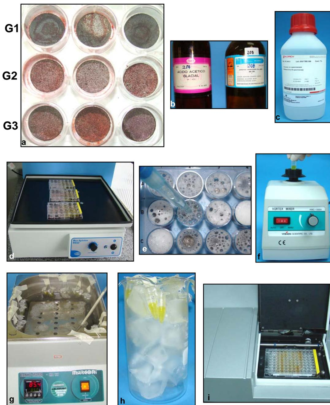
Figura 7 – **Nódulos de mineralização**: a) placa contendo amostras coradas com vermelho Alizarina; b) ácido acético e cloreto de amônio; c) óleo mineral Sigma; d) mesa agitadora; e) agitação manual com pipeta, para remoção de corante; f-h) seqüência de processamento dos reagentes; i) placa de 96 poços, contendo as alíquotas para leitura, acondicionada no espectrofotômetro.
