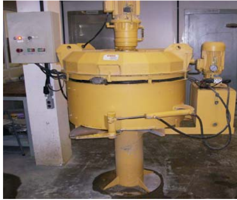
Figura 3.6 - Misturador planetário utilizado na produção dos concretos das vigas 1-3 e 2-3.
