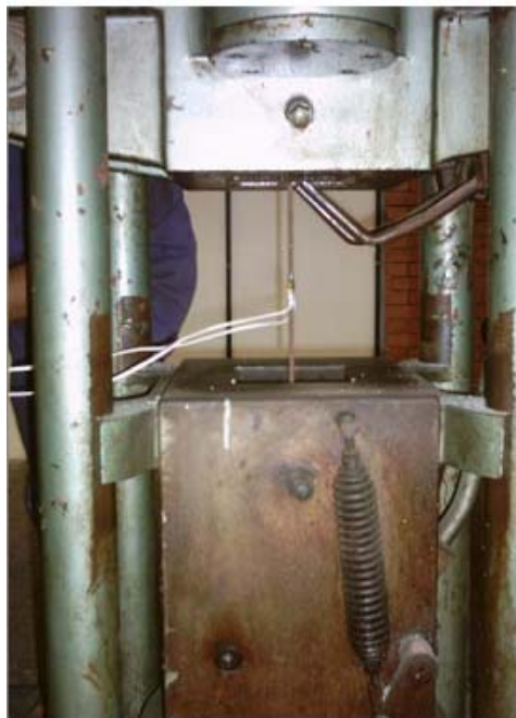
Figura 3.13 - Ensaio de tração em barra de aço.
