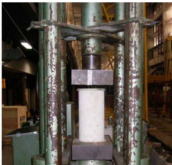
Figura 3.17 - Execução do ensaio de resistência à compressão.
