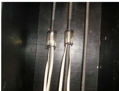
Figura 3.9 - Extensômetros elétricos utilizados nas barras longitudinais de tração.
