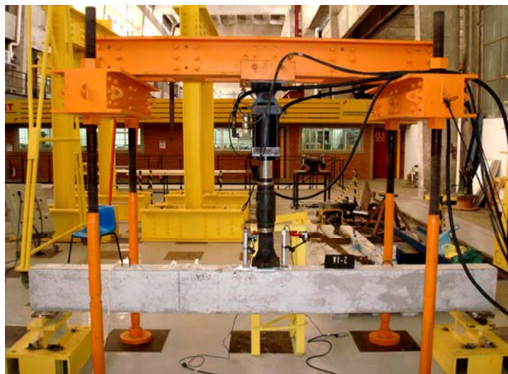
Figura 3.30 - Esquema de ensaio das vigas.
