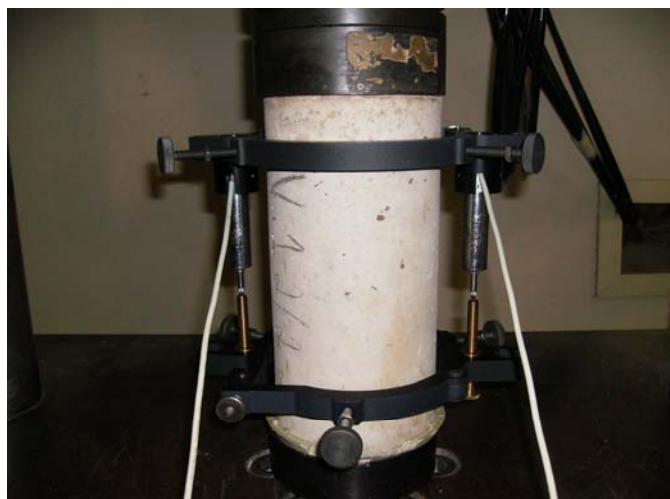
Figura 3.18 - Transdutores usados para medição das deformações específicas.
