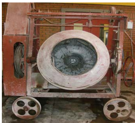
Figura 3.5 - Betoneira utilizada na produção dos concretos das vigas 1-1, 1-2, 2-1 e 2-2.
