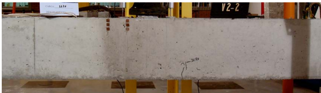
(a) P = 20,0 \text{ kN} . ( \sim 1,23 P_{cr} e 30\% P_u ).
