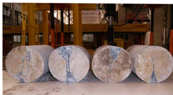
(b) corpos-de-prova já ensaiados.
